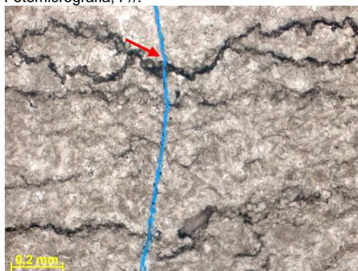
Figura 299i – Detalhe da fratura aberta cortando estilólitos. Fotomicrografia, P//.
