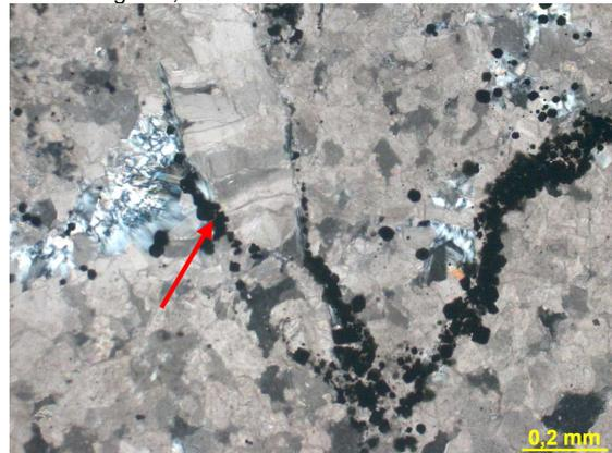
Figura 313g – Plano de estilolito com pirita e sílica. Fotomicrografia, PX.
