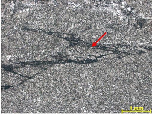
Figura 281d – Detalhe do dolomito fino a médio com filmes de dissolução (seta). Fotomicrografia, P//.
