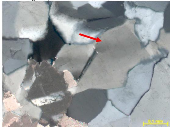
Figura 303g – Detalhe do cimento de quartzo. Fotomicrografia, PX.
