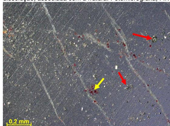
Figura 303i – Setas vermelhas indicando cristais de pirita e seta amarela indicando cristais de óxido/hidróxido de Fe (pirita oxidada? - cor vermelha). Fotomicrografia, Luz refletida.
