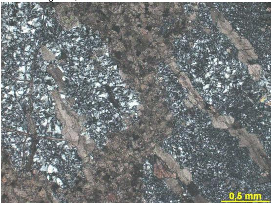
Figura 313h – Porção silicificada cortada por fraturas. Fotomicrografia, PX.
