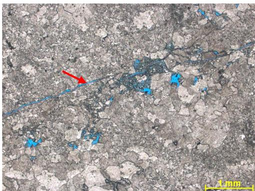
Figura 279b – Seta indicando fratura com porosidade associada. Fotomicrografia, P//.
