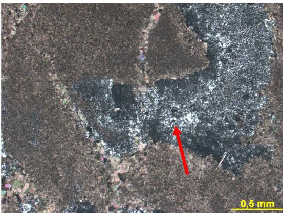
Figura 319f – Detalhe da silicificação substituindo uma porção da rocha, inclusive fraturas cimentadas pré-existentes. Fotomicrografia, polarizadores cruzados (PX).
