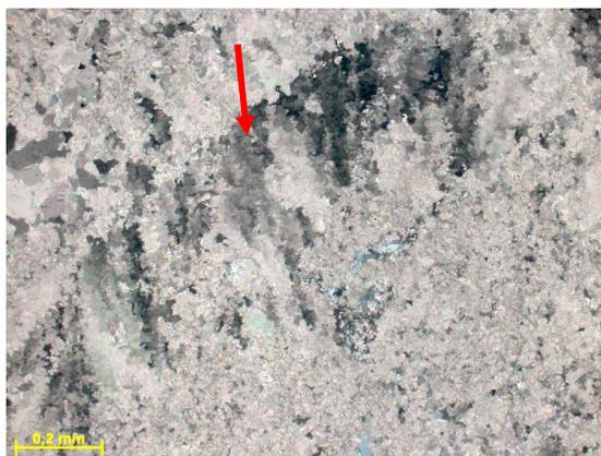
Figura 304c – Detalhe dentro do seixo aonde os cristais de dolomita são maiores, por vezes alongados, e apresentam um arranjo radial, com extinção ondulante - fragmento de estrutura microbial?. Fotomicrografia, PX.
