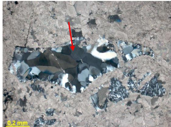
Figura 311g – Detalhe do cimento de quartzo – alguns cristais com extinção ondulante. Fotomicrografia, PX.
