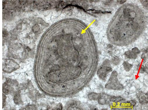
Figura 292e – Detalhe de oolito com núcleo de intraclasto carbonático (seta amarela). Seta vermelha indicando cimento calcítico do tipo mosaico grosso. Fotomicrografia, P//.
