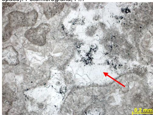
Figura 302g – Detalhe da porosidade vugular cimentada por calcita, com cristais de pirita associados. Fotomicrografia, P//.
