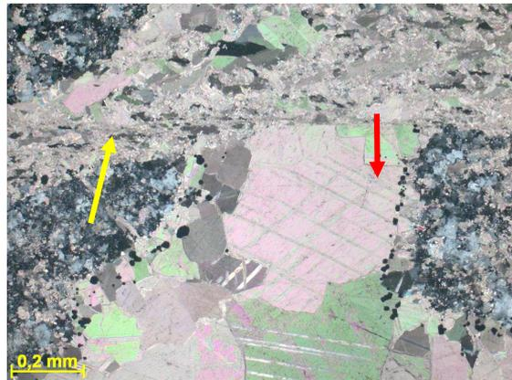
Figura 310i – Seta vermelha indicando cimento dolomítico com cristais de pirita nas bordas e seta amarela indicando zona de cisalhamento com cristais de dolomita alongados. Fotomicrografia, PX.
