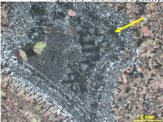
Figura 307b – Seta indicando silicificação da rocha e possivelmente cimentação. Fotomicrografia, PX.
