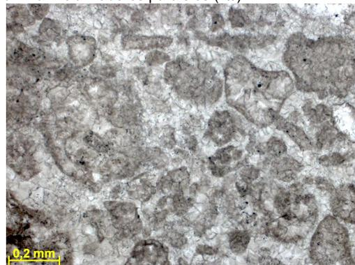
Figura 301c – Detalhe do calcarenito intraclástico peloidal intensamente cimentado por calcita. Notar que o contato entre os grãos é dos tipos flutuante e pontual. Fotomicrografia, P//.
