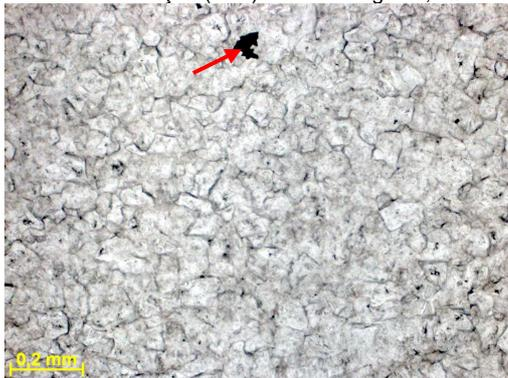
Figura 281f – Detalhe do dolomito fino a médio. Seta indicando cristal de pirita. Fotomicrografia, P//.
