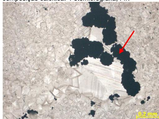
Figura 294i – Detalhe da porosidade secundária do tipo vugular cimentada por pirita framboidal (mineral opaco) e calcita blocosa. Fotomicrografia, P//.
