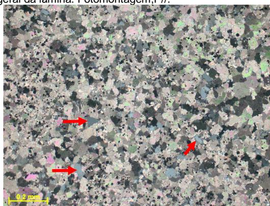
Figura 306c – Setas indicando cristais de quartzo tamanho silte dispersos na rocha. Fotomicrografia, PX.
