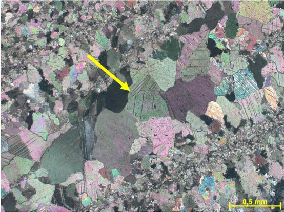
Figura 307d – Detalhe de porção da rocha aonde os cristais de dolomita são mais grossos e com formas mais regulares, tratando-se provavelmente de cimentação. Fotomicrografia, PX.
