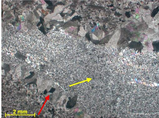
Figura 273d – Detalhe do vug com borda cimentada por dolomita-em-sela (seta vermelha) e centro cimentado por finos cristais de dolomita e calcita. Fotomicrografia, PX.
