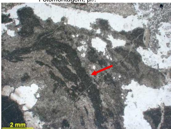
Figura 319b – Detalhe da estrutura laminada arqueada (estrutura estromatolítica?). As laminações são diferenciadas pelo tamanho dos cristais de dolomita (os níveis mais escuros apresentam cristalinidade mais fina). Fotomicrografia, polarizadores paralelos (P//).
