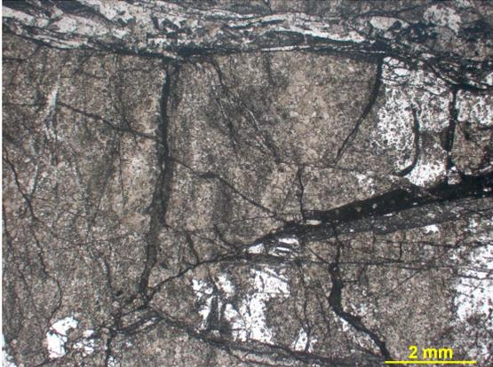
Figura 311d – Porção intensamente fraturada com dolomita mais grossa e limpa associada. Fotomicrografia, P//.
