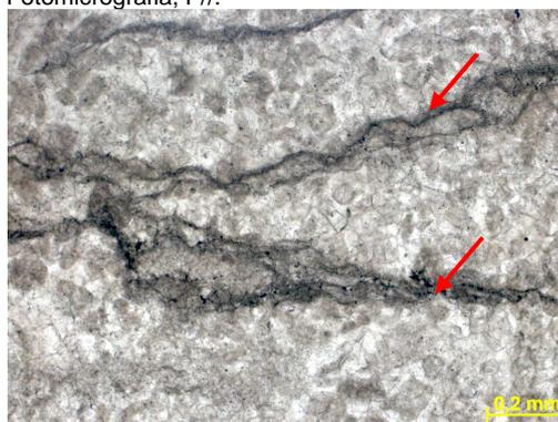
Figura 287g – Detalhe dos filmes de dissolução com concentração de matéria orgânica e pirita. Fotomicrografia, P//.
