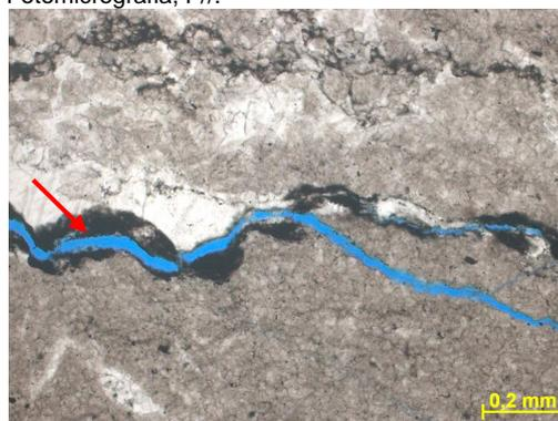
Figura 286i – Seta indicando estilolito no contato entre calcarenito (parte superior da foto) e calcilitito (parte inferior da foto), com porosidade secundária do tipo canal em grande parte seguindo o plano do estilolito. Fotomicrografia, P//.
