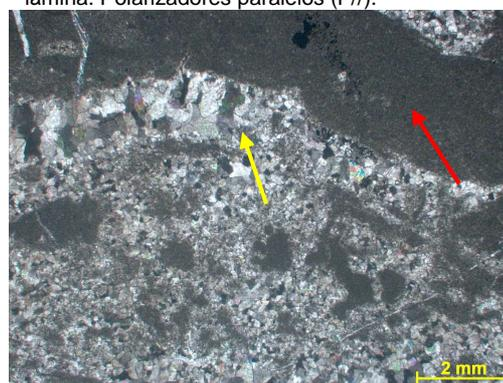
Figura 273c – Seta vermelha indicando nível de dololuto(?) e seta amarela indicando cimento dolomítico. Fotomicrografia, PX.
