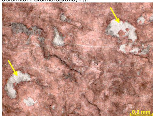
Figura 299g – Setas indicando cimentação por dolomita-em-sela. Lâmina tingida por uma solução de Alizarina e Ferricianeto de Potássio, evidenciando em vermelho as porções de composição calcítica. Fotomicrografia, P//.
