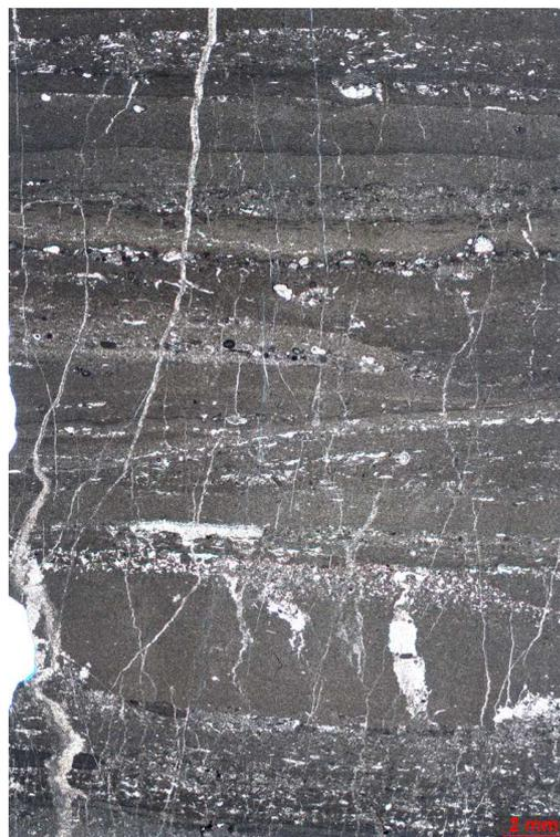
Figura 270a – Dolarenito peloidal laminado, com oolitos. Vista geral da lâmina. Polarizadores paralelos (P//).
