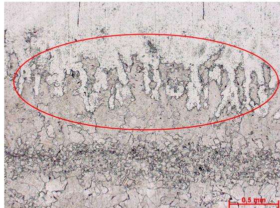
Figura 307i – Círculo indicando interdigitação da sílica com o carbonato (sílica substituindo dolomita). A sílica aparece na porção superior da foto. Fotomicrografia, P//.
