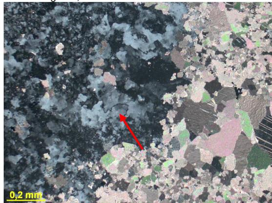
Figura 315e – Seta indicando sílica substituindo parcialmente a rocha. Fotomicrografia, PX.
