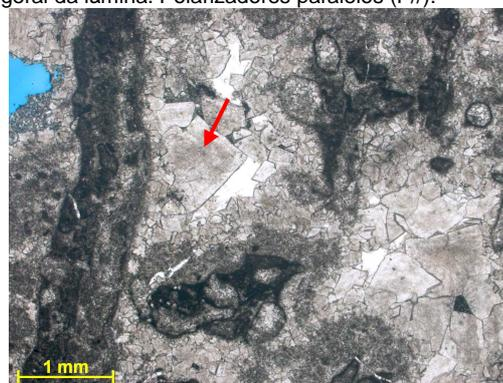
Figura 272c – Seta indicando cimento dolomítico. Fotomicrografia, P//.
