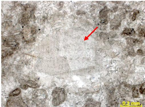
Figura 292f – Seta indicando cimento calcítico do tipo blocoso. Fotomicrografia, P//.
