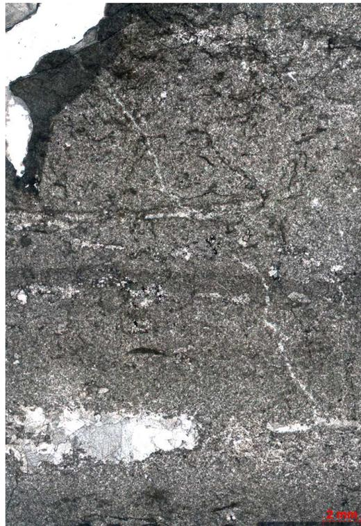
Figura 287a – Calcarenito muito fino a fino (com raro grão tamanho areia grossa), peloidal, com alguns intraclastos carbonáticos, raros grãos oolíticos e laminação incipiente. Vista geral da lâmina. Polarizadores paralelos (P//).
