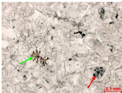
Figura 283i – Seta vermelha indicando núcleo de dolomita com cristais de pirita e seta verde indicando óxido de Mn(?). Fotomicrografia, P//.
