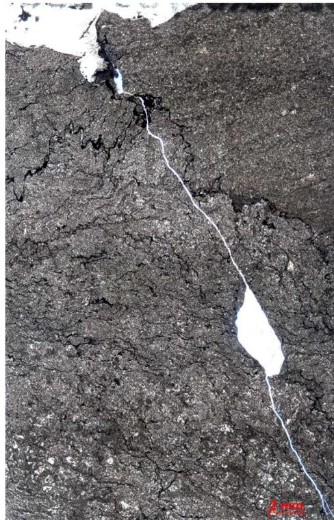
Figura 300a – Calcarenito muito fino, peloidal, com intraclastos carbonáticos(?), intensamente recristalizado e cimentado por calcita. Vista geral da lâmina. Polarizadores paralelos (P//).
