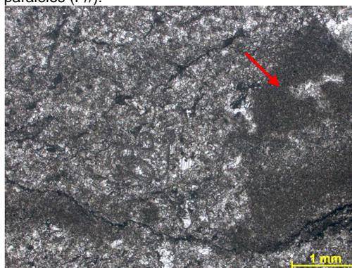
Figura 297c – Seta indicando fragmento intraclástico no calcarenito. Fotomicrografia, P//.
