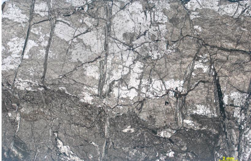
Figura 311a – Dolomito fino a grosso intensamente fraturado e parcialmente silicificado. Visão geral da amostra. Fotomontagem, p//.
