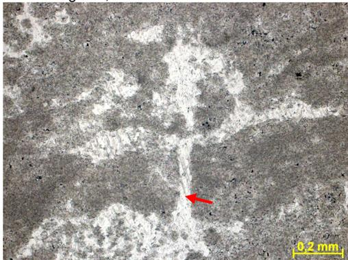
Figura 267f – Detalhe de microfratura cimentada por calcita. Fotomicrografia, P//.
