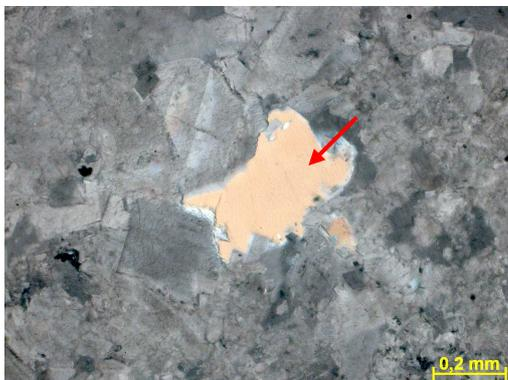
Figura 281h – Seta indicando cimento de quartzo associado a cimento dolomítico. Fotomicrografia, PX.
