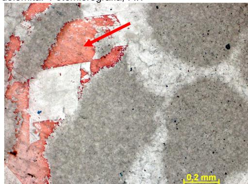
Figura 273i – Seta indicando parte da rocha que foi dissolvida e cimentada por calcita e dolomita. Lâmina tingida por solução de Alizarina e Ferricianeto de Potássio, evidenciando em vermelho as porções de composição calcítica. Fotomicrografia, P//.
