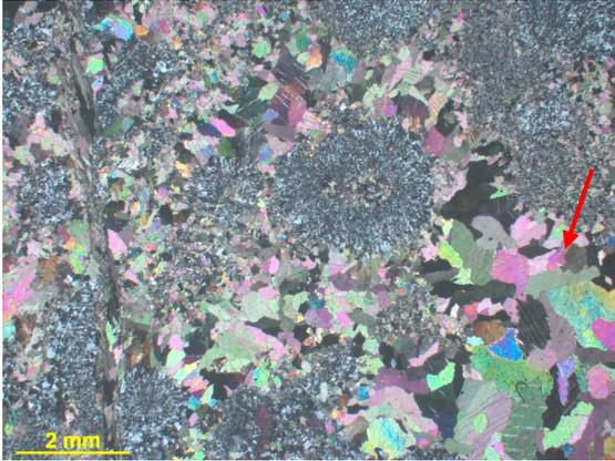
Figura 316d – Seta indicando cristais de dolomita mais grossos, tratando-se possivelmente de cimentação. Fotomicrografia, PX.
