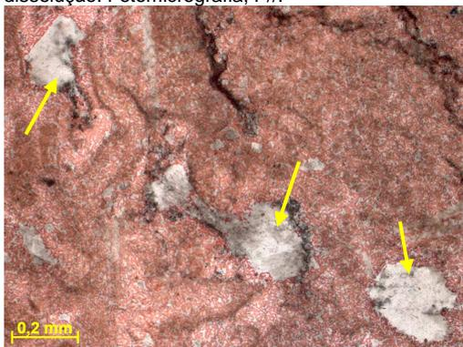
Figura 300h – Setas indicando cimentação por dolomita-em-sela. Lâmina tingida por uma solução de Alizarina e Ferricianeto de Potássio, evidenciando em vermelho as porções de composição calcítica. Fotomicrografia, P//.
