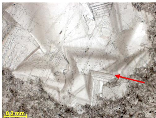
Figura 287i – Detalhe dos cristais zonados de calcita blocosa cimentando porosidade vugular. Fotomicrografia, P//.
