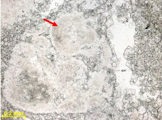
Figura 310d – Seta indicando possível oolito intensamente silicificado dentro de fragmento lítico. Fotomicrografia, P//.
