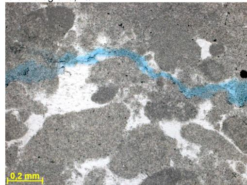
Figura 268j – Detalhe da porosidade secundária do tipo canal (cor azul). Fotomicrografia, P//.
