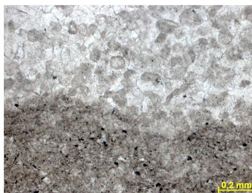
Figura 293c – Detalhe do contato entre calculutito (na base) e calcarenito cimentado por calcita (no topo). Fotomicrografia, P//.
