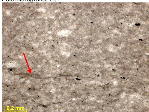
Figura 288f – Detalhe do calcilitito. Seta indicando filme de dissolução Fotomicrografia, P//.
