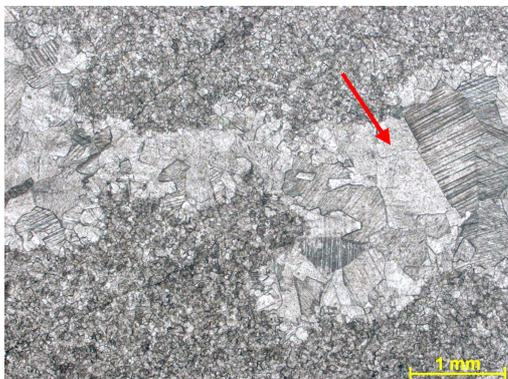
Figura 285h – Detalhe de porosidade secundária do tipo vugular cimentada por calcita blocosa. Fotomicrografia, P//.
