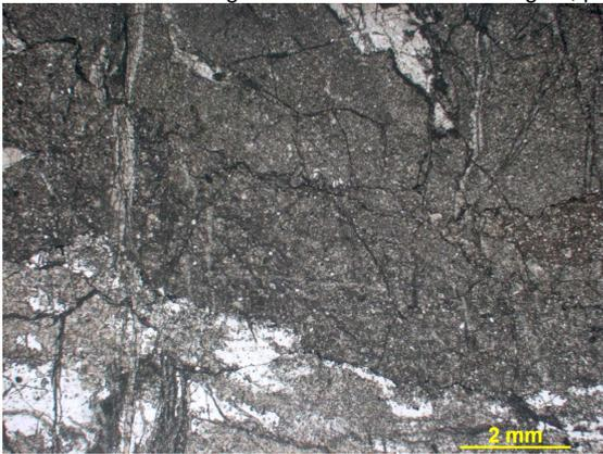
Figura 311b – Dolomito fino a grosso, intensamente fraturado, parcialmente silicificado. Fotomicrografia, P//.
