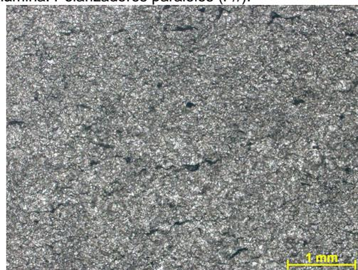
Figura 298c – Detalhe do calcarenito muito fino peloidal. Fotomicrografia, P//.
