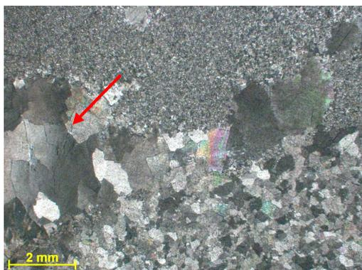
Figura 275b – Seta indicando cimento de dolomita-em-sela. Fotomicrografia, PX.
