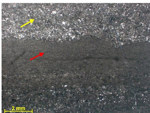
Figura 271b – Seta amarela indicando nível intraclástico com cimento dolomítico entre os grãos e seta vermelha indicando nível peloidal com matriz carbonática entre os grãos. Fotomicrografia, P//.
