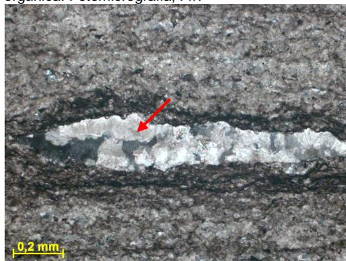
Figura 296i – Detalhe do nível com cristais de calcita crescendo em direção ao centro – porosidade cimentada?. Fotomicrografia, PX.
