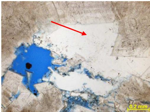
Figura 280h – Seta indicando cimento de quartzo. Fotomicrografia, P//.
