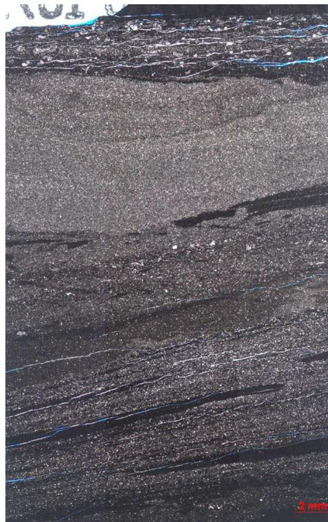
Figura 284a – Arenito muito fino carbonático, com intercalação de níveis delgados de lamito. Vista geral da lâmina. Polarizadores paralelos (P//).
