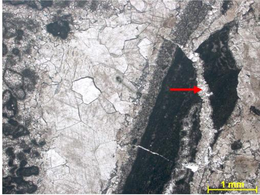
Figura 272d – Seta indicando fratura no fragmento intraclástico cimentada por dolomita. Fotomicrografia, P//.
