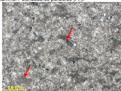
Figura 283c – Detalhe do calcarenito fino a médio intensamente recristalizado. Setas indicando fantasmas de grão. Fotomicrografia, P//.
