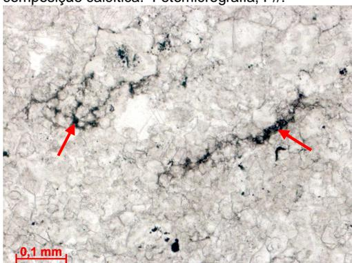
Figura 283h – Detalhe da matéria orgânica piritizada entre cristais de calcita. Fotomicrografia, P//.
