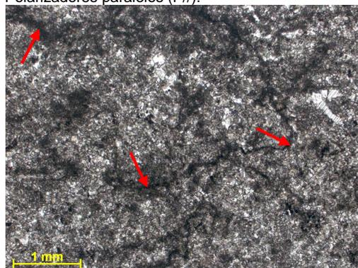
Figura 287c – Setas indicando filmes de dissolução com concentração de matéria orgânica e pirita no calcarenito fino a muito fino. Fotomicrografia, P//.
