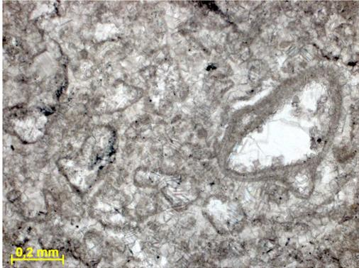
Figura 297d – Detalhe do calcarenito intraclástico, peloidal. Fotomicrografia, P//.
