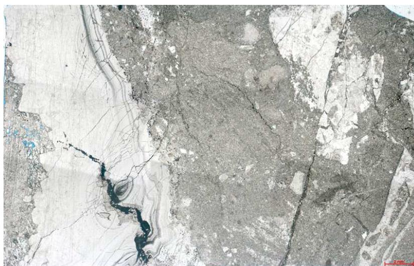
Figura 306a – Dolomito fino a médio, com porções de cristalinidade grossa a muito grossa, parcialmente silicificado. Vista geral da lâmina. Fotomontagem, P//.
