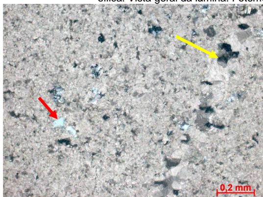
Figura 303b – Detalhe de fragmento carbonático. Seta vermelha indicando grão de quartzo tamanho areia muito fina e seta amarela indicando fratura cimentada por dolomita. Fotomicrografia, P//.
