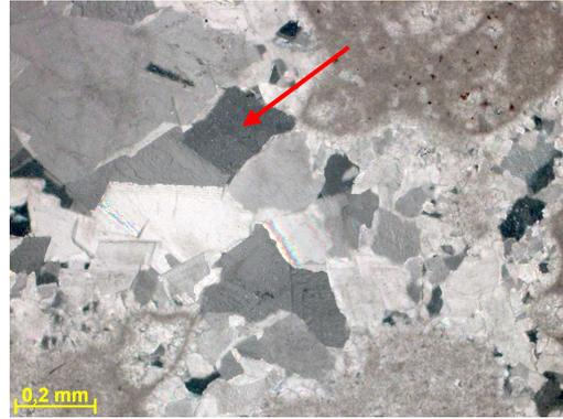
Figura 272e – Seta indicando cimento de dolomita (dolomita blocosa). Fotomicrografia, P//.
