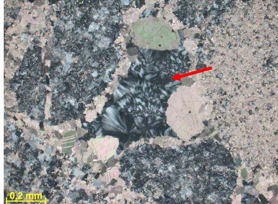
Figura 310e – Poro com borda cimentada por dolomita e núcleo cimentado por sílica (calcedônia). Fotomicrografia, PX.
