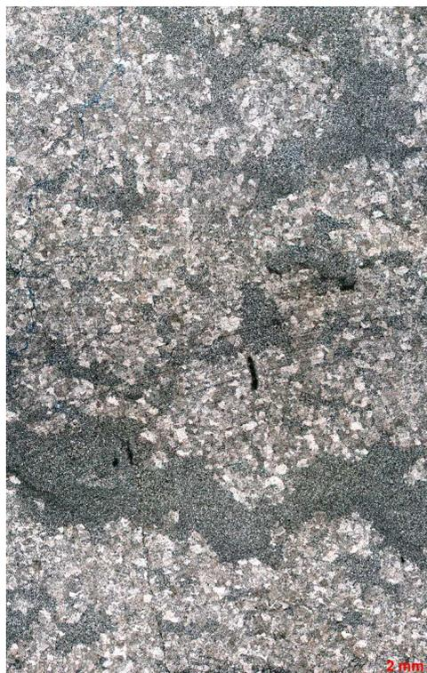
Figura 277a – Dolomito grosso a muito grosso, com porções de cristalinidade fina a muito fina. Vista geral da lâmina. Polarizadores paralelos (P//).
