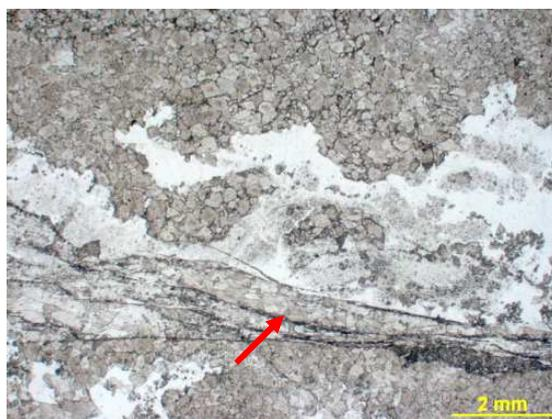
Figura 319c – Seta indicando zona de fratura com silicificação associada. A sílica aparece com cor clara/branca na foto. Fotomicrografia, P//.
