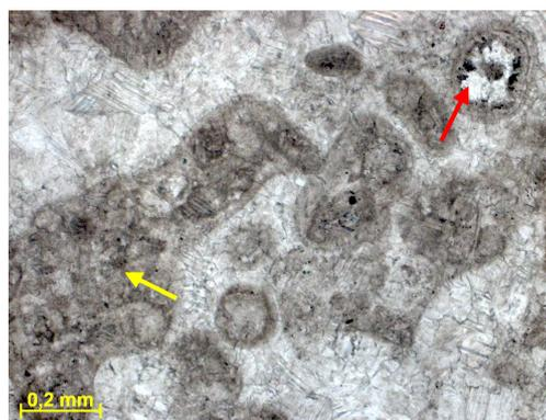
Figura 292c – Seta vermelha indicando oolito e seta amarela indicando intraclasto carbonático. Notar intensa cimentação por calcita. Fotomicrografia, P//.
