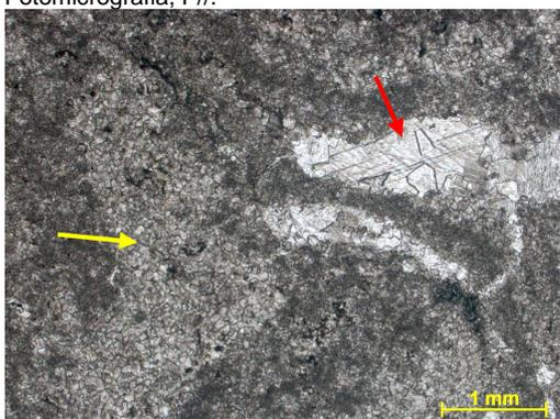
Figura 286f – Seta amarela indicando porção da rocha com maior quantidade de cimento calcítico do tipo mosaico e seta vermelha indicando porosidade vugular cimentada por calcita blocosa. Fotomicrografia, P//.
