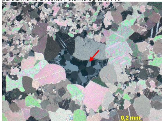
Figura 315g – cimentação de sílica (cristais maiores e limpos, com bordas regulares). Fotomicrografia, PX.
