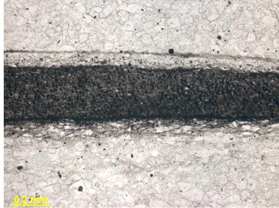
Figura 317e – Detalhe do nível escuro, rico em pirita – estrutura gerada por compactação?. Fotomicrografia, P//.
