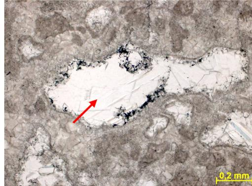
Figura 301e – Detalhe de porosidade secundária do tipo móldica cimentada principalmente por calcita blocosa. Fotomicrografia, P//.
