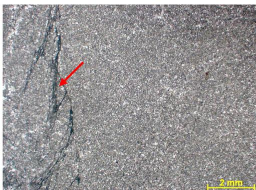
Figura 281b – Seta indicando filmes de dissolução. Fotomicrografia, P//.
