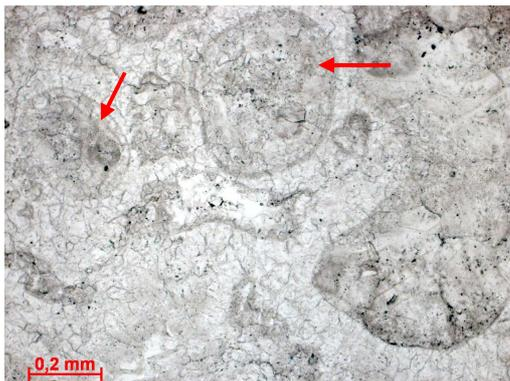
Figura 291d – Setas indicando oolitos. Fotomicrografia, P//.
