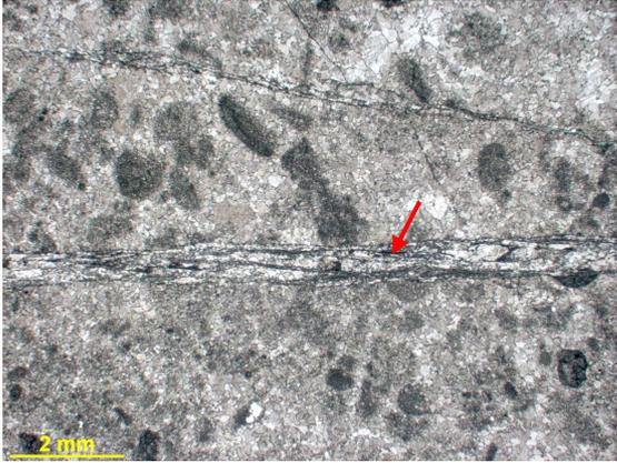
Figura 312d – Dolarenito. Seta indicando plano de falha. Fotomicrografia, P//.
