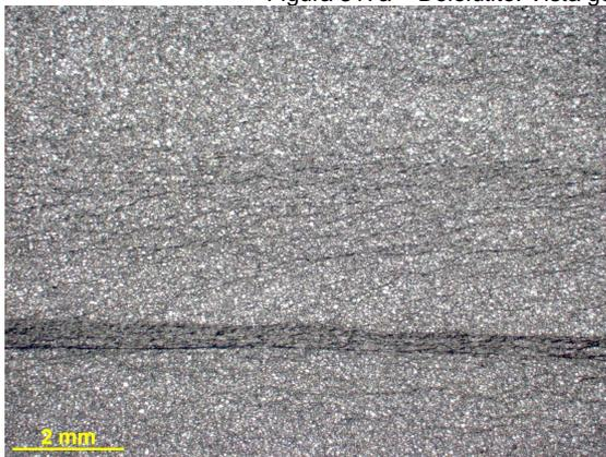
Figura 317b – Detalhe do dololuto rico em filmes de dissolução. Fotomicrografia, P//.
