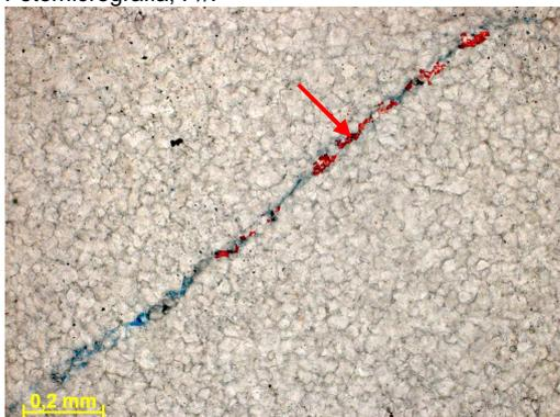
Figura 276h – Seta indicando cimentação de calcita na fratura. Lâmina tingida por solução de Alizarina e Ferricianeto de Potássio, evidenciando em vermelho as porções de composição calcítica. Fotomicrografia, P//.
