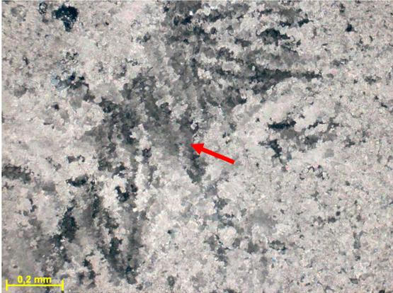
Figura 304d – Detalhe dentro do seixo aonde os cristais de dolomita são maiores, por vezes alongados, e apresentam um arranjo radial, com extinção ondulante - fragmento de estrutura microbial?. Fotomicrografia, PX.
