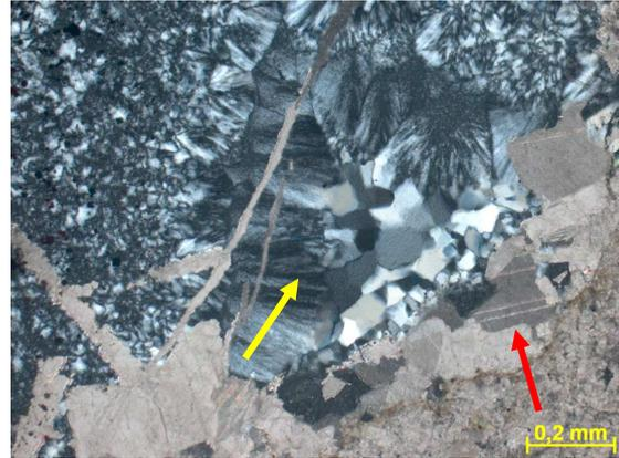
Figura 303e – Seta vermelha indicando cimento de dolomita na borda do fragmento carbonático e seta amarela indicando cimento silicoso (notar várias fases de cimentação). Fotomicrografia, PX.
