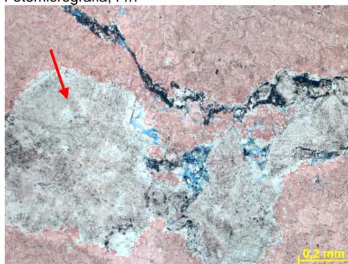
Figura 291i – Detalhe da porosidade secundária cimentada por dolomita-em-sela (seta) próxima a plano de estilólito. Lâmina tingida por uma solução de Alizarina e Ferricianeto de Potássio, evidenciando em vermelho as porções de composição calcítica. Fotomicrografia, P//.
