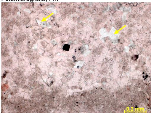
Figura 286h – Detalhe do calcarenito intensamente cimentado por calcita e recrystalizado. Setas indicando cristais de dolomita. Lâmina tingida por uma solução de Alizarina e Ferricianeto de Potássio, evidenciando em vermelho as porções de composição calcítica. Fotomicrografia, P//.
