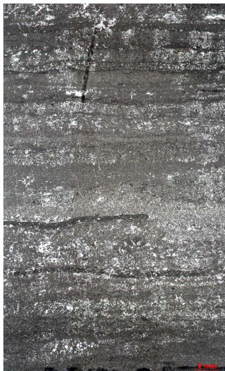
Figura 267a – Dolarenito laminado. Vista geral da lâmina. Polarizadores paralelos (P//).
