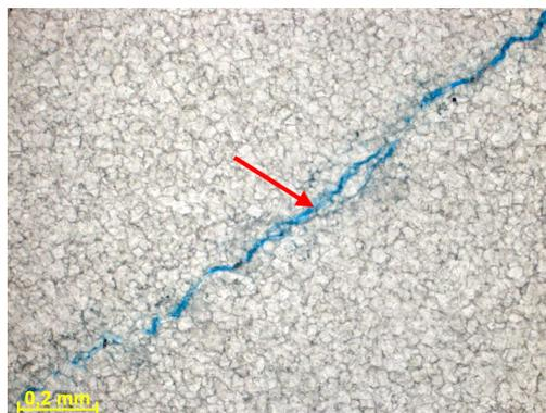
Figura 276g – Detalhe da fratura aberta. Fotomicrografia, P//.
