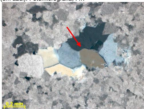
Figura 279i – Seta indicando cimento de quartzo. Fotomicrografia, PX.
