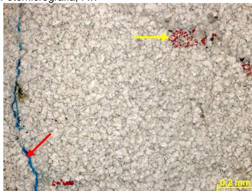
Figura 276i – Seta vermelha indicando fratura aberta e seta amarela indicando cimentação por calcita. Lâmina tingida por solução de Alizarina e Ferricianeto de Potássio, evidenciando em vermelho as porções de composição calcítica. Fotomicrografia, P//.
