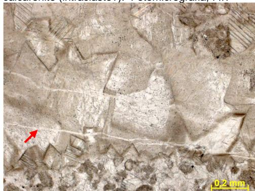
Figura 293g – Detalhe do cimento calcítico blocoso dentro da fratura. Seta indicando microfissura cortando o cimento. Fotomicrografia, P//.
