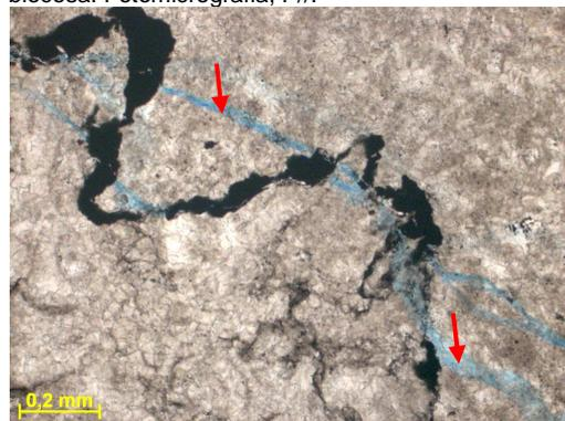
Figura 300i – Setas indicando porosidade do tipo "channel" ao longo de zona com estilólito. Fotomicrografia, P//.
