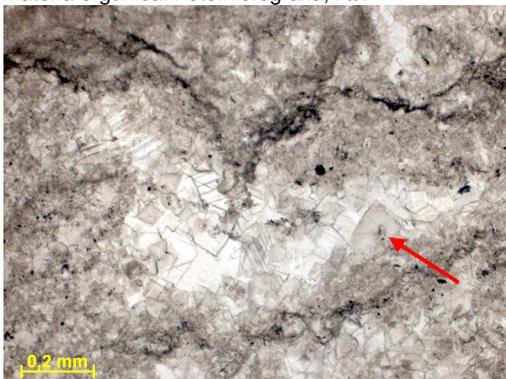
Figura 297h – Seta indicando cimento calcítico crescendo em direção ao centro do poro. Fotomicrografia, P//.
