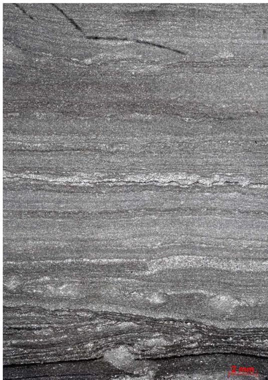
Figura 295a – Calcarenito muito fino a fino, síltico-arenoso, com níveis argilosos, laminado. Vista geral da lâmina. Polarizadores paralelos (P//).
