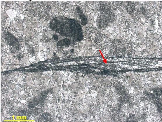
Figura 312h – Detalhe de plano de cisalhamento. Fotomicrografia, P//.
