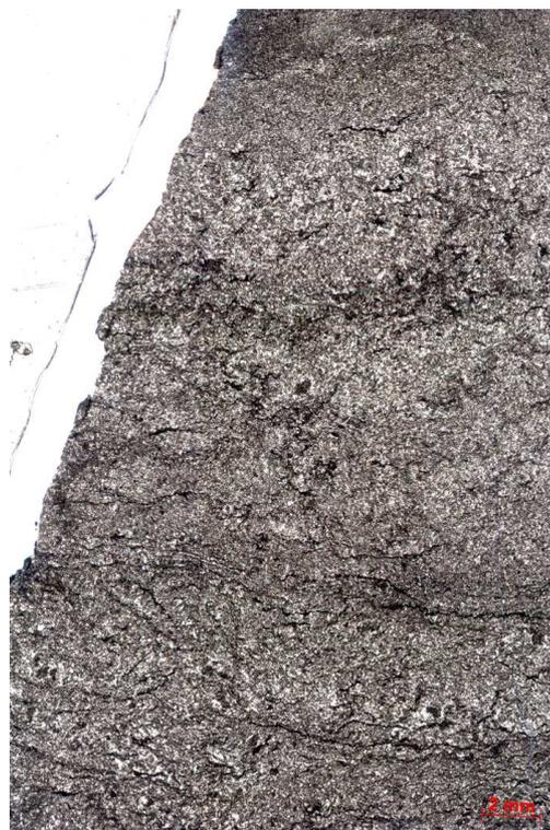
Figura 299a – Calcarenito muito fino a médio, constituído por intraclastos e pelóides(?), intensamente recristalizado e cimentado por calcita. Vista geral da lâmina. Polarizadores paralelos (P//).
