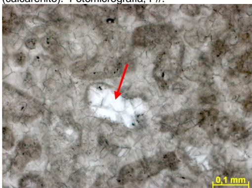
Figura 288g – Seta indicando porosidade móldica (dissolução do grão) cimentada por calcita. Fotomicrografia, P//.
