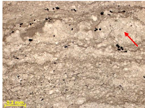
Figura 295g – Seta indicando nível do calcarenito com limites irregulares e granulação mais grossa. Fotomicrografia, P//.
