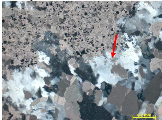
Figura 305i – Detalhe da sílica substituindo a dolomita. Seta indicando quartzo com resquícios de dolomita dentro do cristal. Fotomicrografia, PX.
