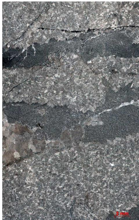
Figura 275a – Dolomito grosso a muito grosso, com níveis de cristalinidade fina. Vista geral da lâmina. Polarizadores paralelos (P//).
