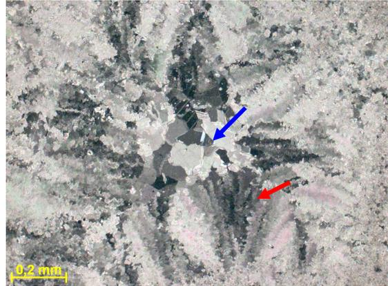
Figura 309e – Seta vermelha indicando dolomita fibro-radial crescendo em direção ao centro da porosidade e seta azul indicando cristais regulares de dolomita obliterando totalmente o espaço poroso. Fotomicrografia, PX.
