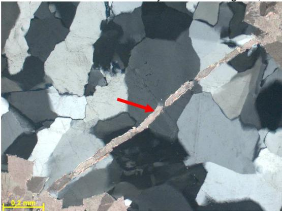
Figura 303h – Seta indicando fratura cimentada por dolomita cortando a porção silicificada. Fotomicrografia, PX.
