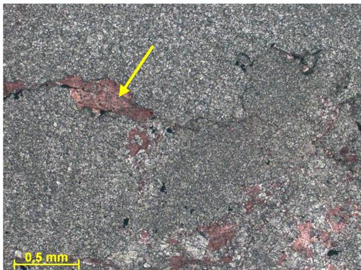
Figura 274f – Detalhe da dissolução ao longo do plano de estilolito, com posterior cimentação por calcita. Lâmina tingida por solução de Alizarina e Ferricianeto de Potássio, evidenciando em vermelho as porções de composição calcítica. Fotomicrografia, P//.
