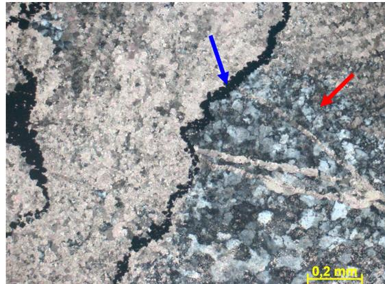
Figura 309g – Seta vermelha indicando porção da rocha silicificada, cortada por fraturas cimentadas por dolomita. Seta azul indicando estilolito com concentração de cristais de pirita cortando a silicificação e as fraturas. Fotomicrografia, PX.
