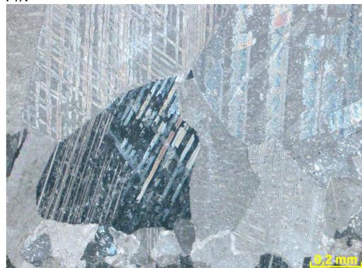
Figura 285i – Calcita blocosa cimentando porosidade vugular. Fotomicrografia, PX.
