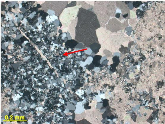
Figura 314h – Detalhe da porção silicificada cortada por fratura cimentada por dolomita. Notar que fratura por vezes desaparece. Fotomicrografia, PX.
