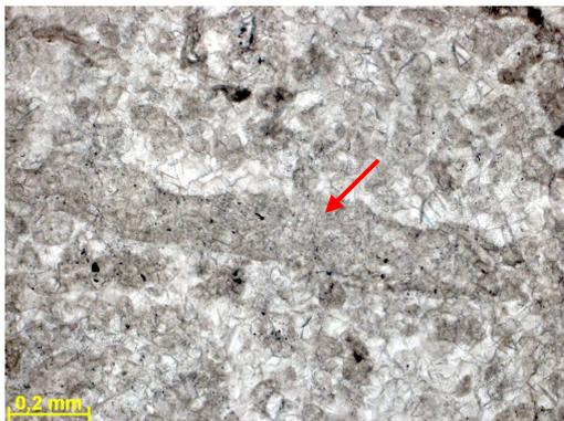
Figura 287d – Seta indicando intraclasto carbonático. Fotomicrografia, P//.
