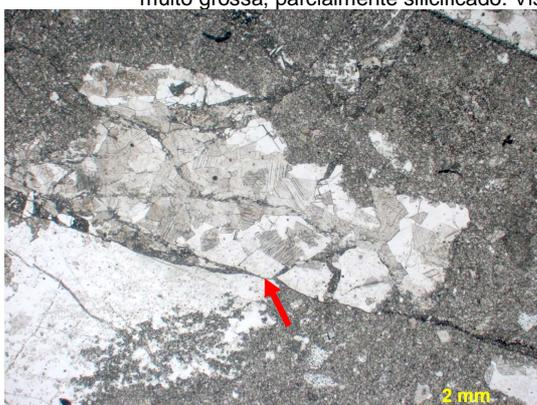
Figura 306b – Detalhe da microfalha cortando porção silicificada. Fotomicrografia, P//.
