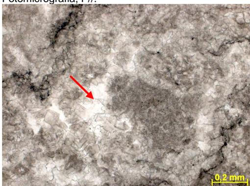
Figura 299f – Detalhe do cimento calcítico entre os grãos carbonáticos. Fotomicrografia, P//.
