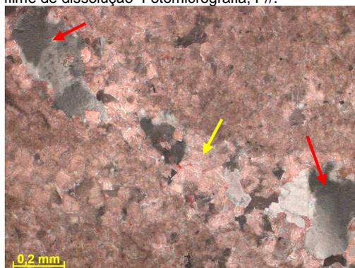
Figura 288h– Detalhe da porosidade vugular cimentada por calcita (seta amarela) e dolomita-em-sela (seta vermelha). Lâmina tingida por uma solução de Alizarina e Ferricianeto de Potássio, evidenciando em vermelho as porções de composição calcítica. Fotomicrografia, P//.
