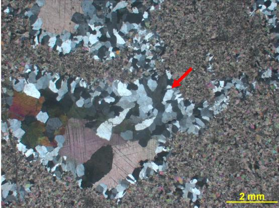
Figura 303d – Detalhe da cimentação por sílica (bordas) e dolomita. Fotomicrografia, PX.
