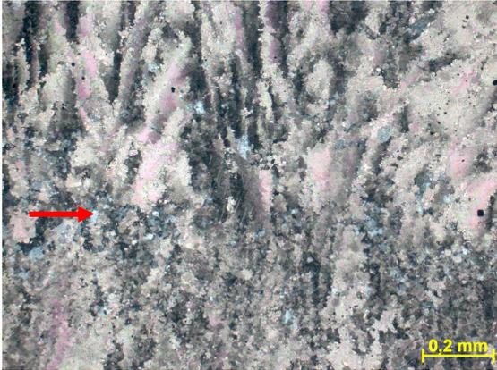
Figura 309d – Seta indicando limite entre duas fases de crescimento da dolomita fibro-radial. Fotomicrografia, PX.
