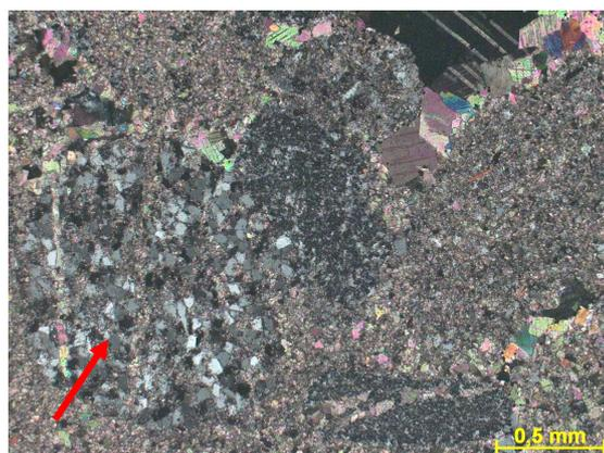
Figura 310c – Seta indicando fragmento lítico de arenito muito fino/siltito(?). Fotomicrografia, PX.
