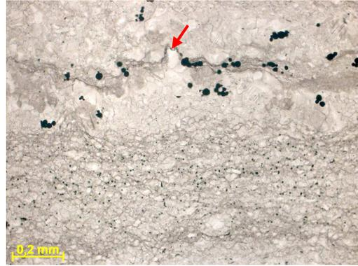
Figura 295e – Seta indicando estilolito em calcarenito fino. Fotomicrografia, P//.
