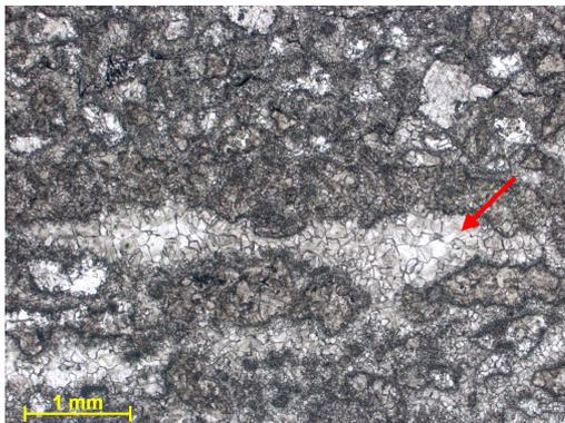
Figura 301b – Detalhe da porosidade fenestral cimentada por calcita. Fotomicrografia, P//.
