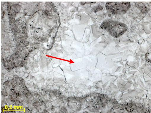
Figura 302d – Detalhe do cimento calcítico blocoso. Fotomicrografia, P//.
