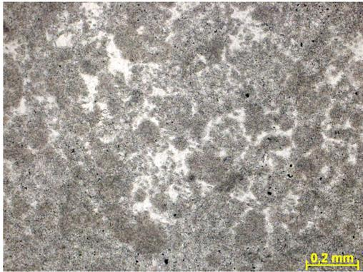
Figura 267d – Detalhe do dolarenito cimentado. Fotomicrografia, P//.
