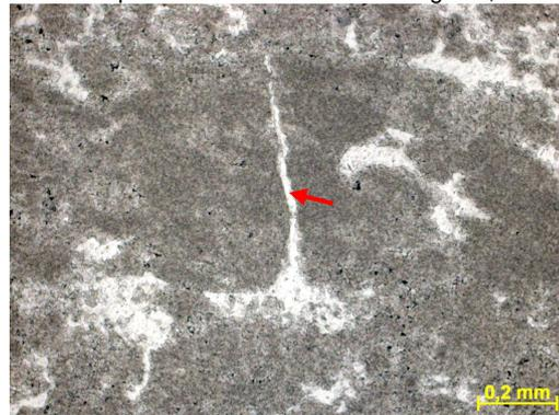
Figura 267g – Detalhe de microfratura cimentada por calcita. Fotomicrografia, P//.
