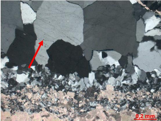
Figura 316f – Detalhe de cristais de quartzo ricos em inclusões fluidas alinhadas. Fotomicrografia, PX.
