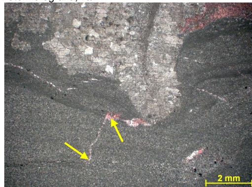
Figura 274g – Seta indicando dissolução ao longo de estilolito e contato entre a matriz e o cimento. Lâmina tingida por solução de Alizarina e Ferricianeto de Potássio, evidenciando em vermelho as porções de composição calcítica. Fotomicrografia, P//.
