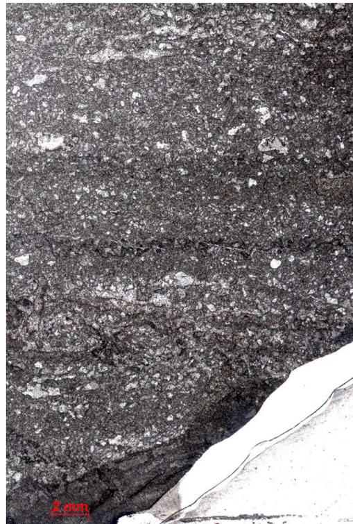
Figura 301a – Calcarenito muito fino a médio, intraclástico e peloidal, com laminação incipiente, intensamente cimentado por calcita. Vista geral da lâmina. Polarizadores paralelos (P//).
