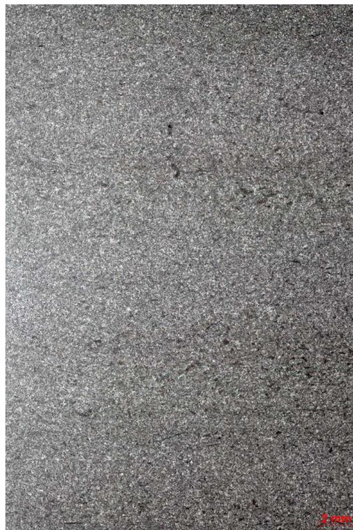
Figura 283a – Calcarenito fino a médio intensamente recristalizado e cimentado por calcita. Vista geral da lâmina. Polarizadores paralelos (P//).
