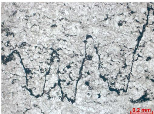
Figura 298h – Detalhe do estilolito no contato entre as litologias. Fotomicrografia, P//.
