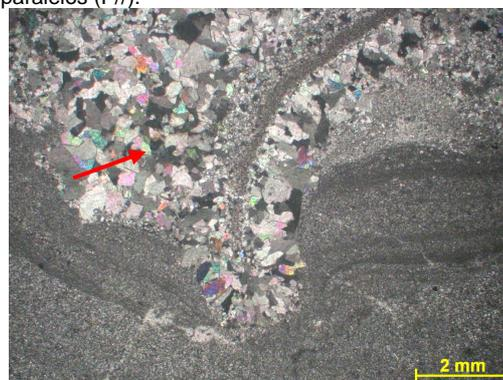
Figura 274c – Detalhe do cimento dolomítico. Fotomicrografia, PX.
