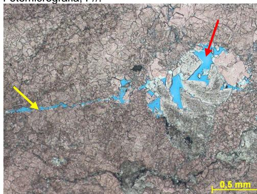
Figura 291g – Seta amarela indicando porosidade secundária do tipo *channel* e seta vermelha indicando porosidade vugular parcialmente cimentada por dolomita-em-sela e calcita blocosa. Lâmina tingida por uma solução de Alizarina e Ferricianeto de Potássio, evidenciando em vermelho as porções de composição calcítica. Fotomicrografia, P//.
