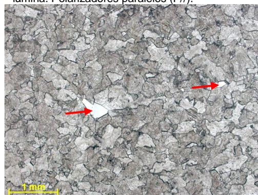
Figura 275c – Detalhe do nível de dolomito grosso. Setas indicando porosidades isoladas (não houve entrada de resina azul). Fotomicrografia, P//.
