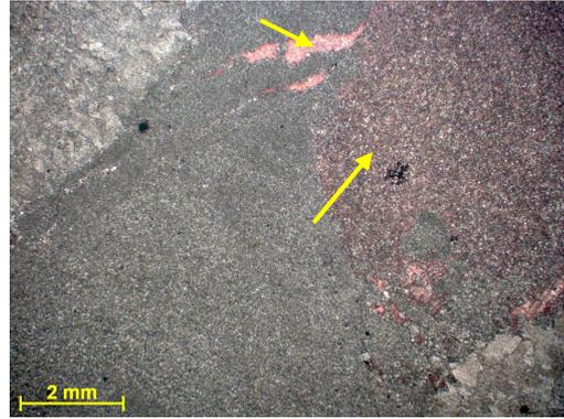
Figura 274e – Setas indicando porções com cimentação calcítica. Lâmina tingida por solução de Alizarina e Ferricianeto de Potássio, evidenciando em vermelho as porções de composição calcítica. Fotomicrografia, P//.
