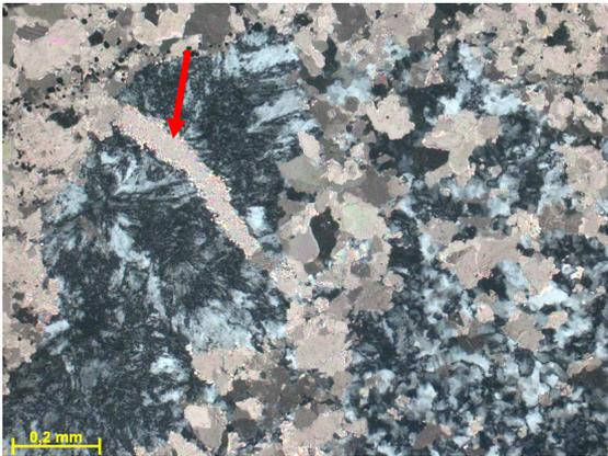
Figura 305h – Seta indicando fratura cimentada por dolomita cortando porção silicificada. Fotomicrografia, PX.
