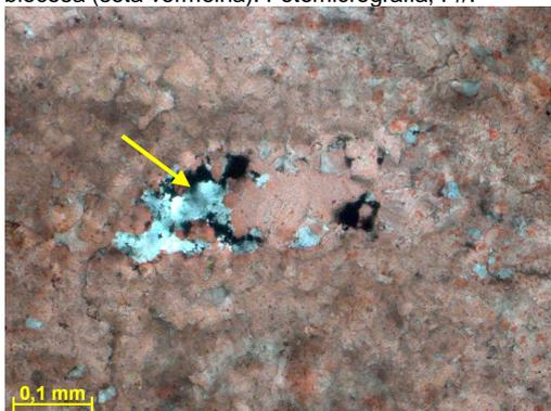
Figura 301h – Seta indicando quartzo e pirita associados cimentando parcialmente porosidade secundária. Lâmina tingida por uma solução de Alizarina e Ferricianeto de Potássio, evidenciando em vermelho as porções de composição calcítica. Fotomicrografia, PX.
