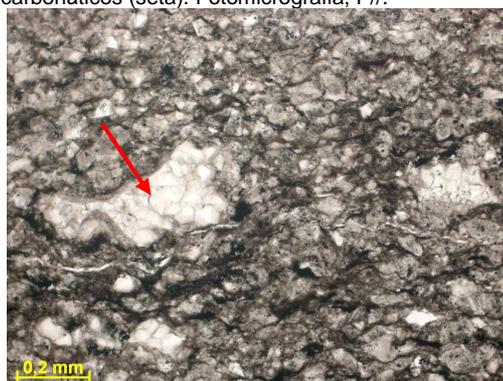
Figura 284g – Seta indicando intraclasto carbonático no arenito muito fino carbonático. Fotomicrografia, P//.
