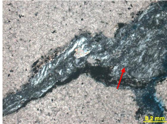
Figura 318g – Detalhe do plano de estilolito com silicificação. Fotomicrografia, PX.
