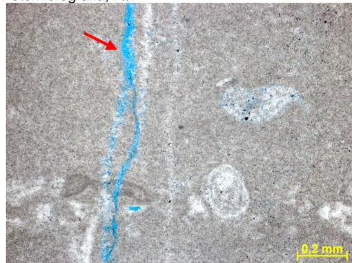
Figura 270g – Seta indicando porosidade secundária (cor azul) seguindo plano de fratura pré-existente. Fotomicrografia, P//.
