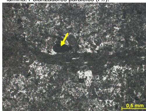
Figura 267c – Detalhe do dolarenito. Seta indicando grãos carbonático. Fotomicrografia, P//.
