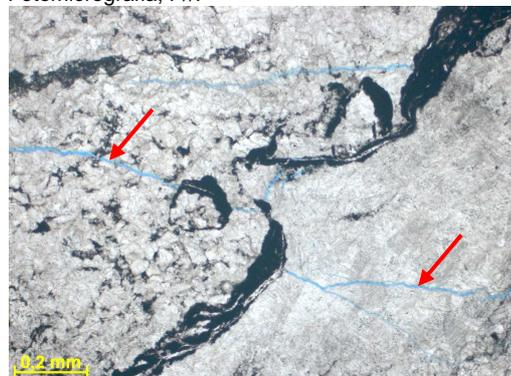
Figura 298i – Setas indicando micro-fraturas abertas ao longo do nível com estilolitos. Fotomicrografia, P//.
