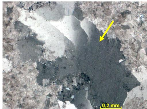
Figura 301g – Detalhe da porosidade secundária cimentada por dolomita-em-sela. Fotomicrografia, PX.
