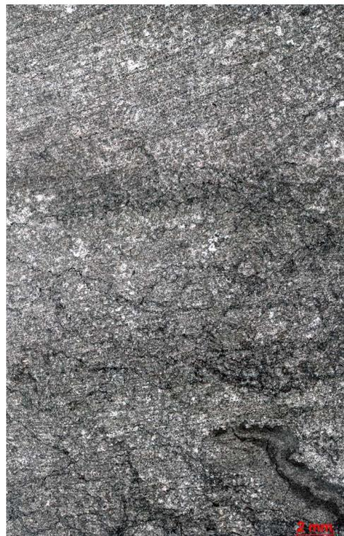
Figura 302a – Calcarenito fino a médio, intraclástico, com pelóides, intensamente cimentado por calcita. Vista geral da lâmina. Polarizadores paralelos (P//).
