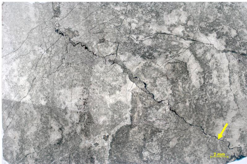
Figura 309a – Dolomito muito fino a médio, localmente silicificado, fraturado. Seta indicando estilólito. Visão geral da amostra. Fotomontagem, P//.
