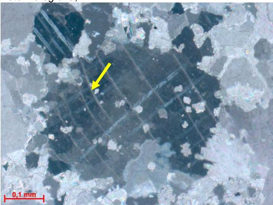
Figura 307f – Seta indicando clivagem curva em cristal de dolomita com extinção ondulante. Notar que o cristal de dolomita apresenta pequenos cristais de dolomita inclusos. Fotomicrografia, PX.
