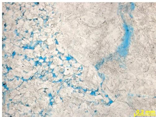
Figura 277g – Detalhe da porosidade secundária gerada por processo de dissolução (em azul). Fotomicrografia, P//.
