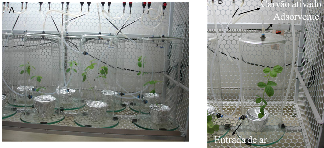
Figura 1: Sistema de Aeração de plantas. A- vista geral do sistema mostrando câmaras de aeração, B- Detalhe de uma câmara mostrando a entrada e saída de ar e a posição do filtro de carvão ativado e do adsorvente.
