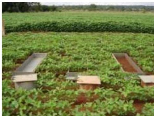
Figura 4.3 - Três calhas de monitoramento do escoamento superficial sob diferentes condições de cobertura (fechada, com vegetação e com solo nu).
