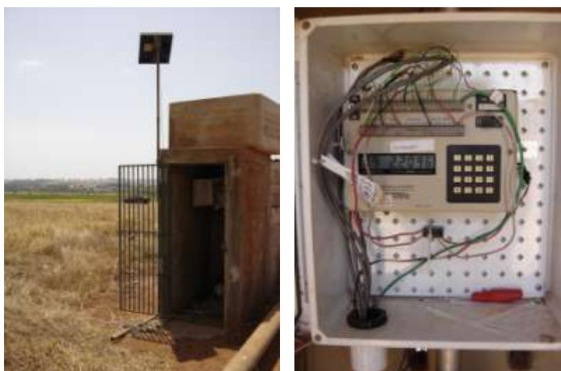
Figura 4.9 - Abrigo de alvenaria onde fica instalado o *datalogger* da Estação Olhos d'Água e o próprio *datalogger*.
