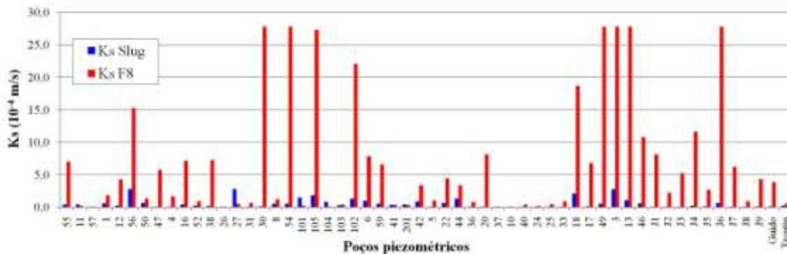
Figura 5.31 - Comparação entre os valores medidos de K<sub>s</sub> Slug e aqueles resultantes do processo de calibração (K<sub>s</sub> F8).
