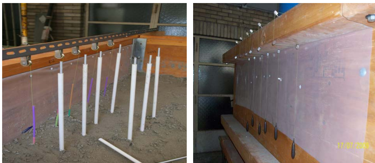
Figura 8.29 – Instrumentação utilizada no ensaio (a) medidores de deslocamentos de superfície. (b) fios flexíveis para obtenção dos deslocamentos na enfilagem.
