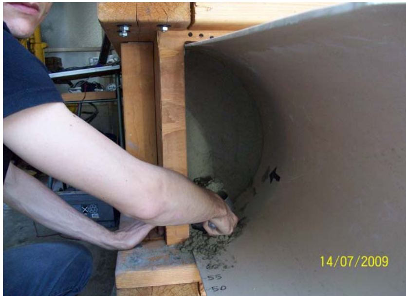
Figura 8.31 – Escavação do emboque.
