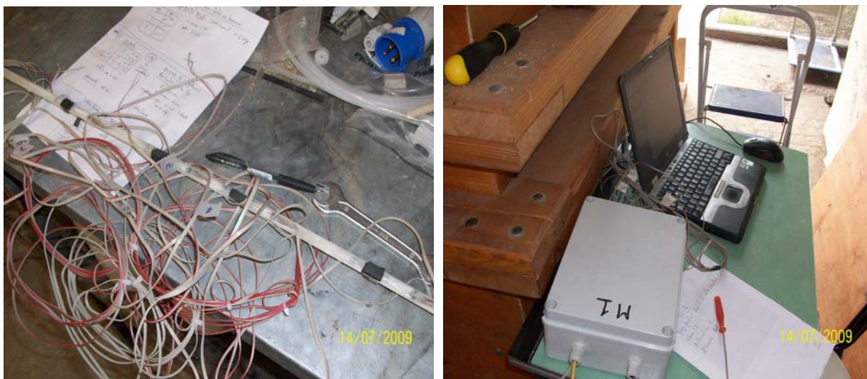
Figura 8.30 – Instrumentação na enfilagem (a) quatro pares de strain gages . (b) sistema de obtenção de dados.
