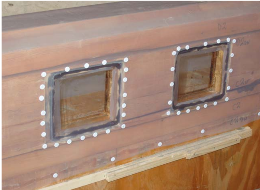
Figura 8.26 – Janelas de inspeção
