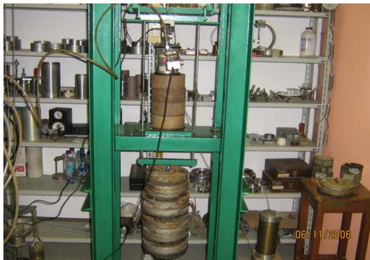
Figura 5.4 – Célula K_0 -UFBa – aplicação do carregamento
