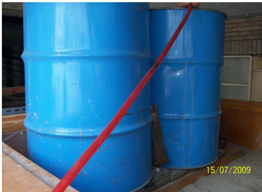
Figura 8.32 – Aplicação da sobrecarga
