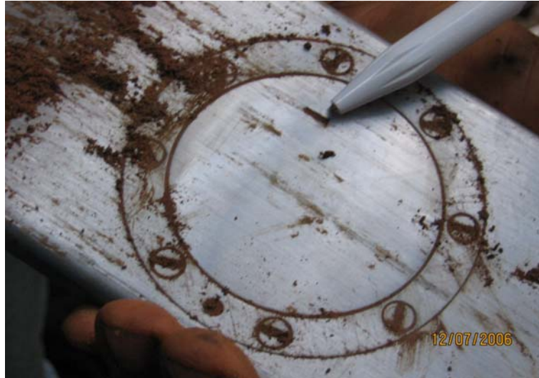
Figura 4.22 – Ruptura da membrana durante a cravação – DMT-01
