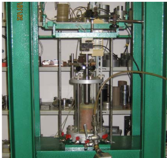
Figura 4.32 - Ensaio triaxial com trajetórias: \Delta\sigma_1 = -\Delta\sigma_3 e \Delta\sigma_1 = -2.\Delta\sigma_3 e condição de adensamento \sigma_3 = K_0.\sigma_1 .
