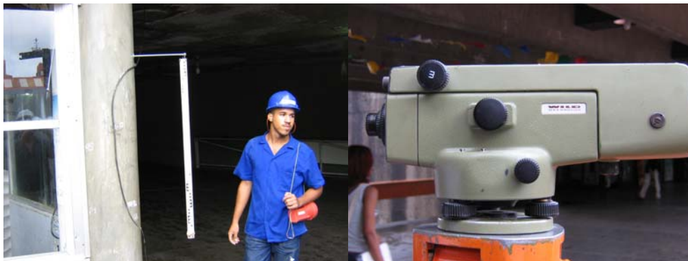
Figura 7.30 – (a) Leitura topográfica dos pinos de recalques instalados no pilar frontal da pizzaria. (b) Equipamento utilizado
