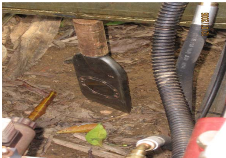
Figura 4.17 – Ensaio de DMT realizado ao topo do túnel – Detalhe da palheta
