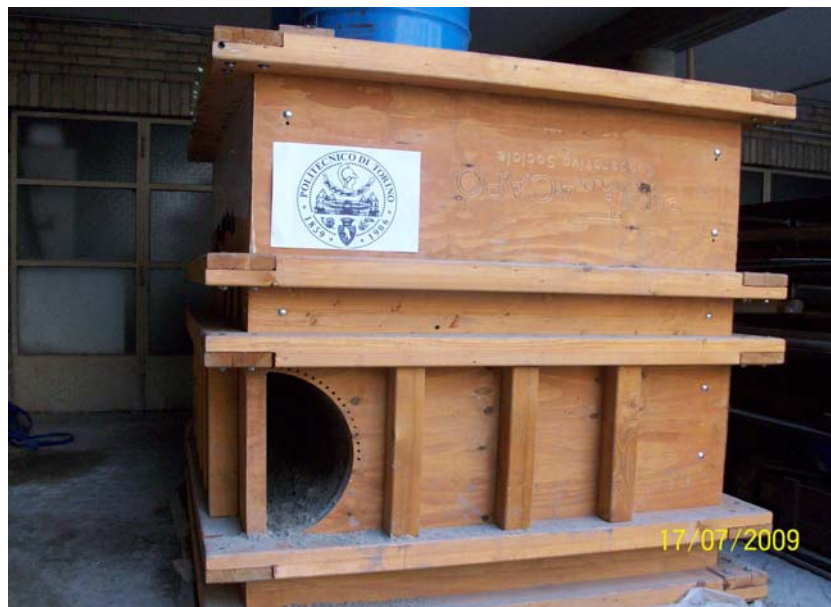
Figura 8.23 – Caixa de areia e semi-túnel
