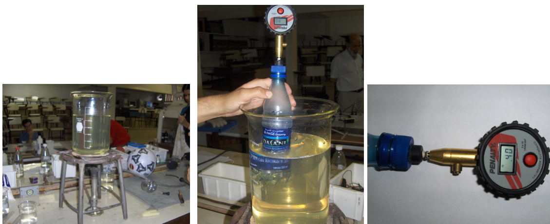
Fotos – Sistema construído para representar a transformação isocórica.
