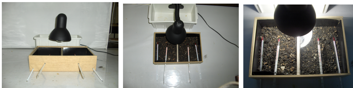
Fotos – Sistema construído para representar o fenômeno do efeito estufa
