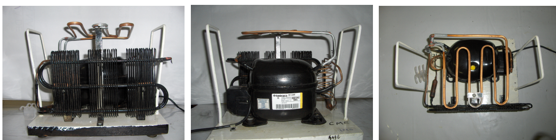
Fotos – Sistema construído para representar o funcionamento do refrigerador
