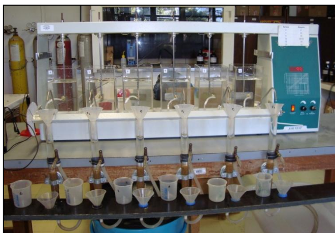
Figura 4.2 – Equipamento para teste de jarros adaptados para filtração direta.
