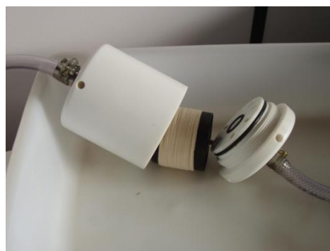
Figura A.2 – Detalhe do encaixe do Filta-Max ® , IDEXX
