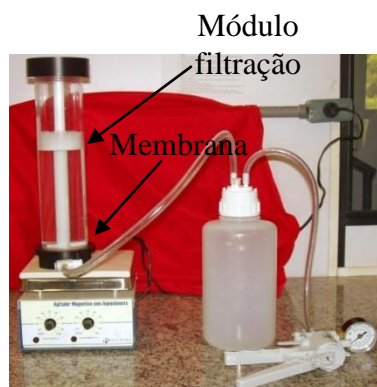
Figura A.5 – Filtração a vácuo em membrana utilizando bomba a vácuo manual
