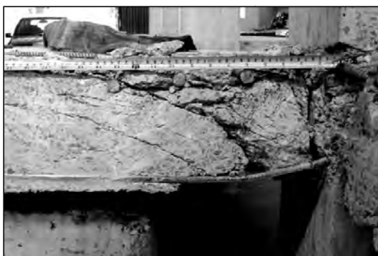
Figura 4.114 – Superfície de ruptura da laje LS08
