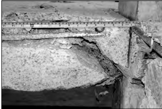
Figura 4.111 – Superfície de ruptura da laje LS05
