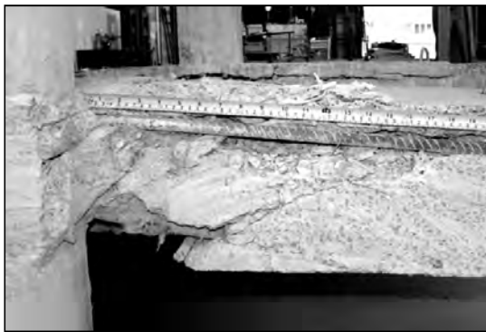
Figura 4.103 – Superfície de ruptura da laje LC05
