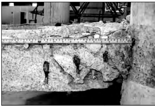
Figura 4.106 – Superfície de ruptura da laje LC08
