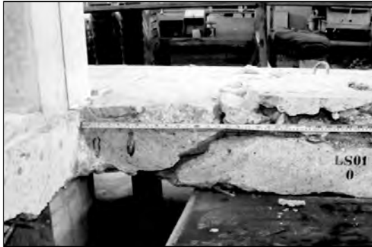
Figura 4.107 – Superfície de ruptura da laje LS01
