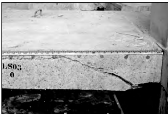
Figura 4.109 – Superfície de ruptura da laje LS03
