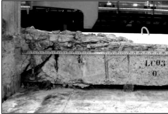
Figura 4.101 – Superfície de ruptura da laje LC03
