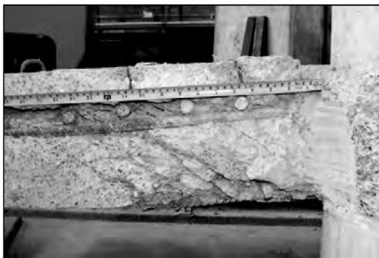
Figura 4.104 – Superfície de ruptura da laje LC06
