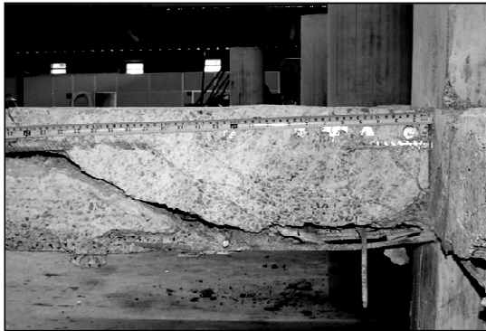
Figura 4.113 – Superfície de ruptura da laje LS07
