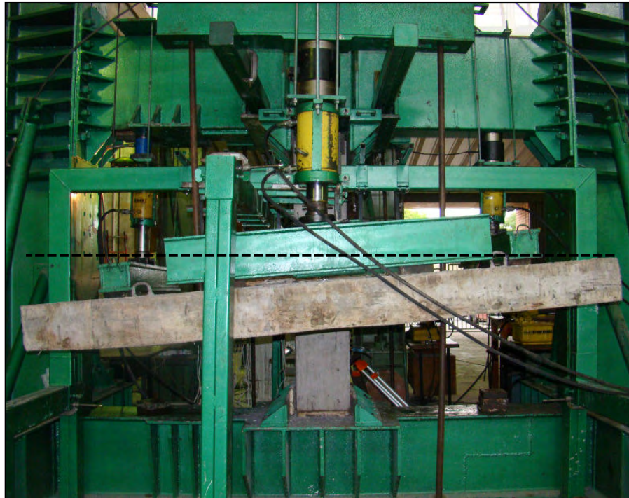
Figura 4.20 – Deslocamentos da laje LS08 pouco antes da ruptura
