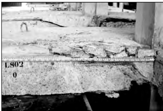
Figura 4.108 – Superfície de ruptura da laje LS02
