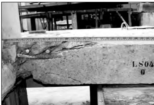
Figura 4.110 – Superfície de ruptura da laje LS04
