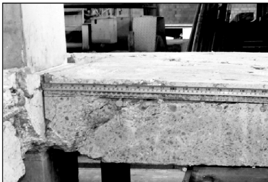
Figura 4.107 – Superfície de ruptura da laje LS01
