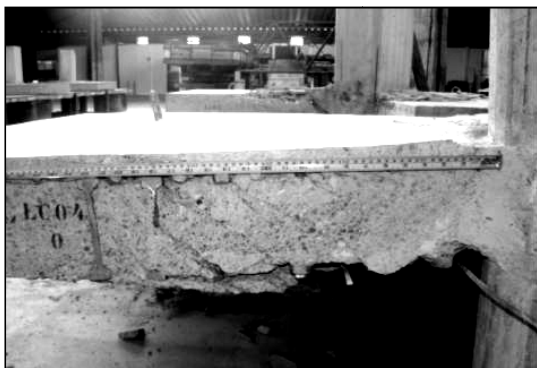
Figura 4.102 – Superfície de ruptura da laje LC04
