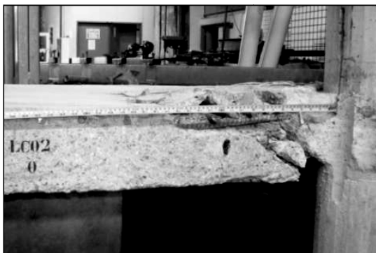
Figura 4.100 – Superfície de ruptura da laje LC02
