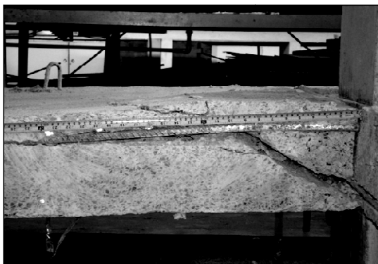
Figura 4.112 – Superfície de ruptura da laje LS06
