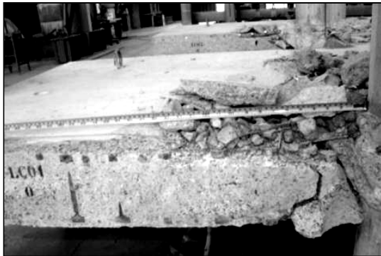
Figura 4.99 – Superfície de ruptura da laje LC01
