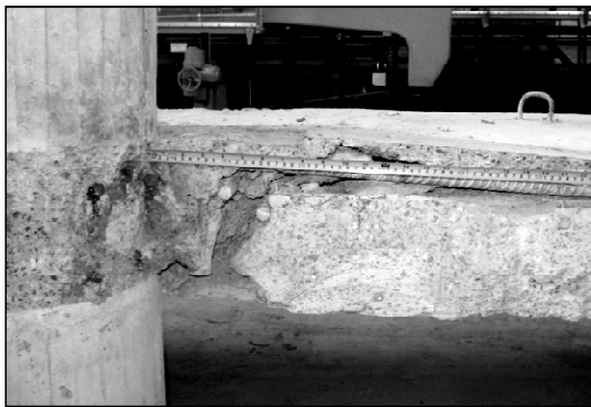
Figura 4.105 – Superfície de ruptura da laje LC07
