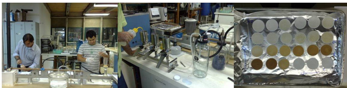
Figura 5.12 – Manuseio de amostra para filtração, sistema de filtragem ligado a bomba de sucção e filtros após amostras passarem pelo sistema.
