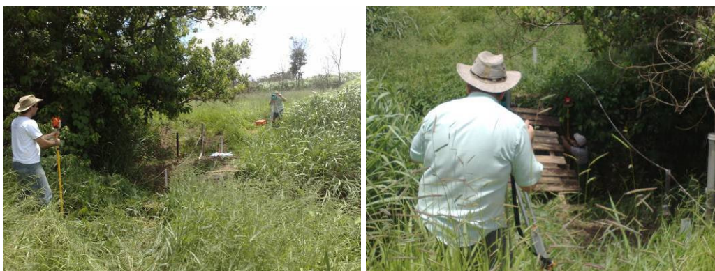
Figura 5.11 – Levantamento altimétrico da seção de controle com Estação Total .
