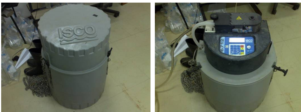
Figura 5.5 – Amostrador do tipo automático ISCO 6712
