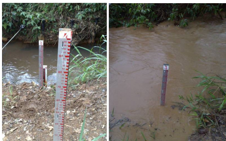
Figura 5.6 – Régua linimétrica instalada na seção de estudo com vazão baixa e alta.
