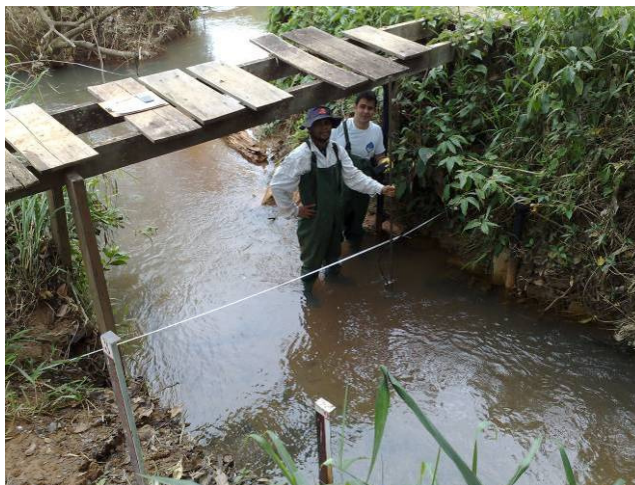
Figura 5.10 – Realização de medição de vazão na seção, com ADV .
