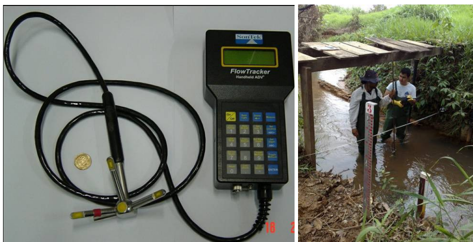
Figura 5.8 – Medidor de velocidade baseado no efeito Doppler (ADV) e medição com equipamento.
