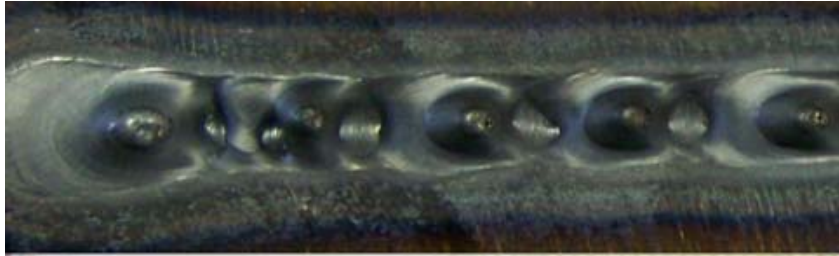
Figura 2.2 - Aspecto de uma solda com Humping .
