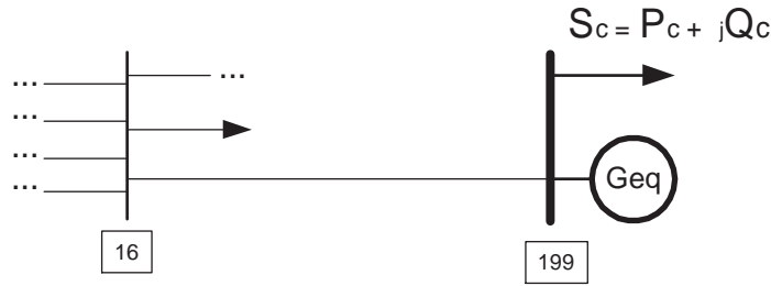
Figura 7.2: Diagrama explicitando as barras de fronteira e do gerador equivalente ao se considerar a área A_2 .
