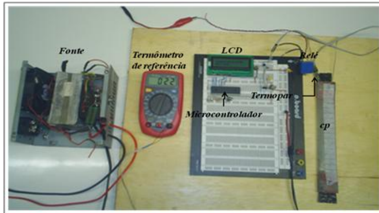
Figura 3.21: Dispositivo para controle da temperatura do fio de SMA.
