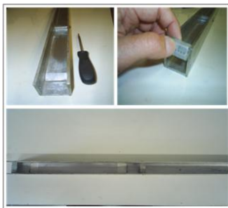
Figura 3.10: Fixação do molde fêmea e guias.
