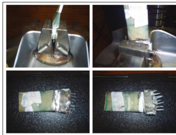
Figura 3.23: Teste da pressão da garra na tab dos CPs.
