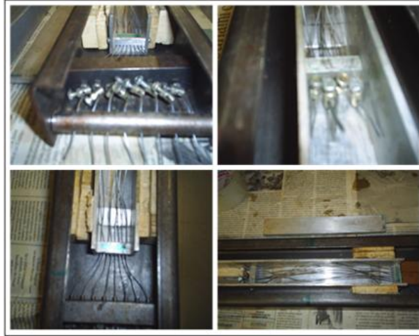
Figura 3.11: Fios, colocados na bancada, presos com parafusos de travamento
