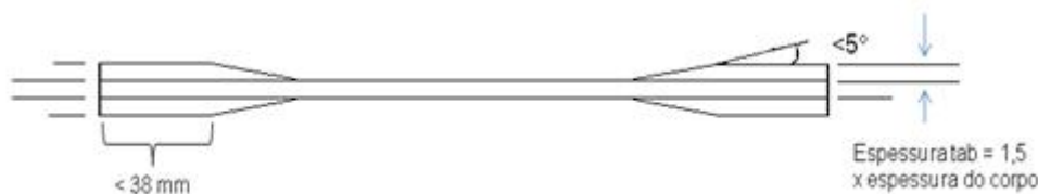
Figura 3.4: Geometria e dimensões do CP segundo a norma ASTM D3030-08
