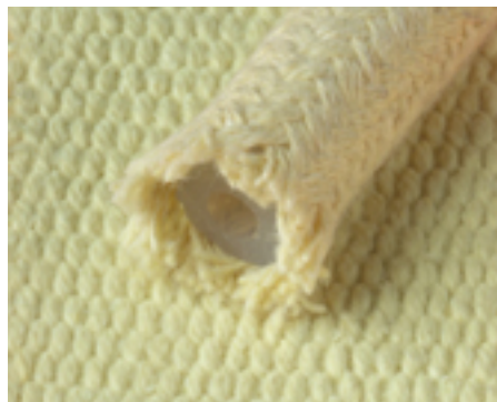
Figura 2.12: Tecido de fibra de aramida (LDA, 2010)
