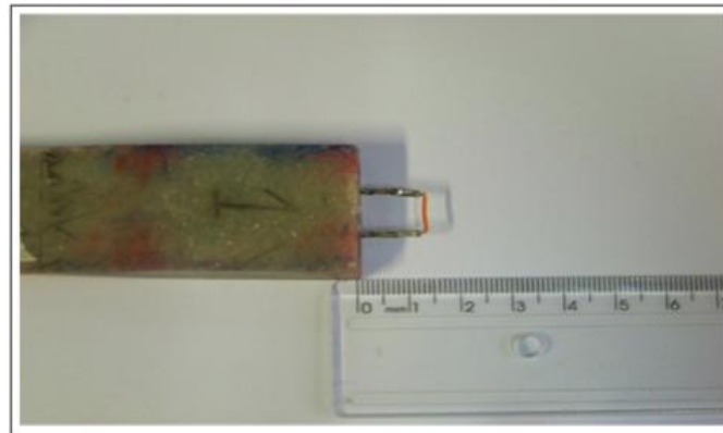
Figura 3.24: Forma da ligação nos fios de SMA nos corpos de prova para testes de tração na fase austenita, T > A_f .
