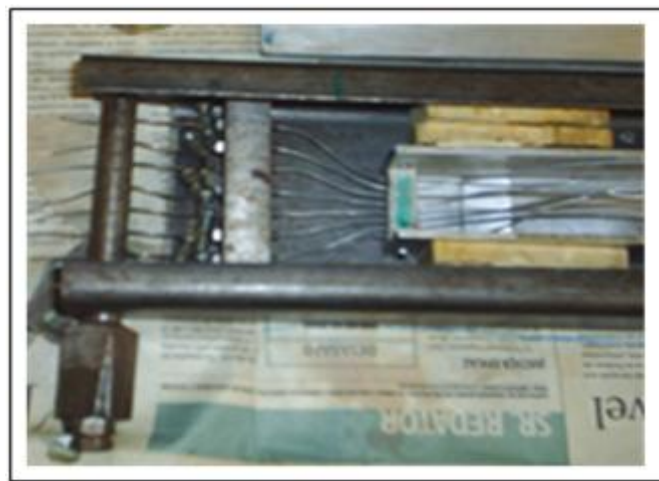
Figura 3.9: Suporte de fixação dos fios de SMA e o dispositivo de esticamento.
