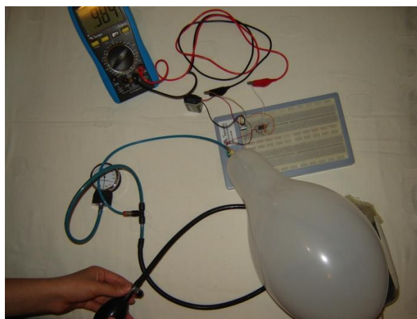
Figura 5.7 - Arranjo montado para avaliar o tempo de resposta do sensor de pressão.
