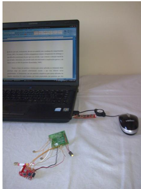
Figura 4.10 - Circuito de aquisição conectado ao kit wireless , as baterias e aos sensores (1 canal de pH e 1 de pressão) e o módulo receptor conectado à porta USB do computador.
