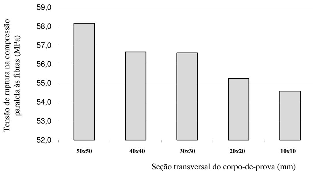
Figura 4.21 - Compressão paralela às fibras - Variação do valor médio da tensão de ruptura, resultante do agrupamento das três espécies.
