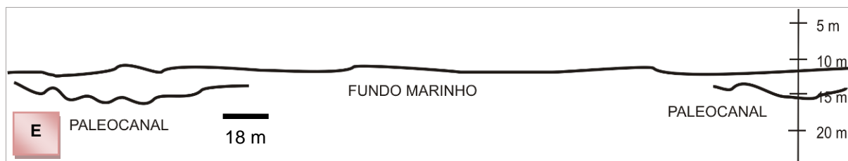
Figura 40 – Figura esquemática da região de canal submerso, na área 1 de trabalho. Em A) e B) o posicionamento da linha nos registros de sonar e perfilador, respectivamente. Em C) e D) os trechos de linha em destaque e em E) a digitalização da interpretação de D).
