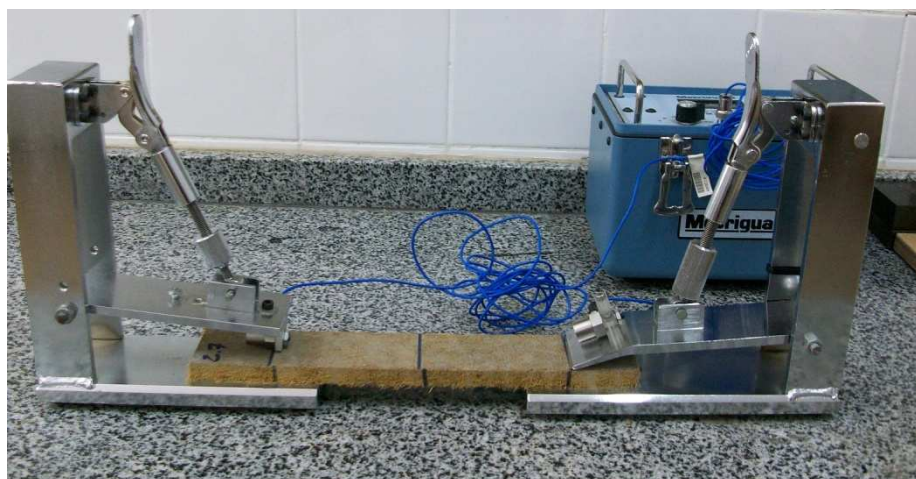
Figura 3.3: Stress Wave Timer utilizado para determinar o E_d .
