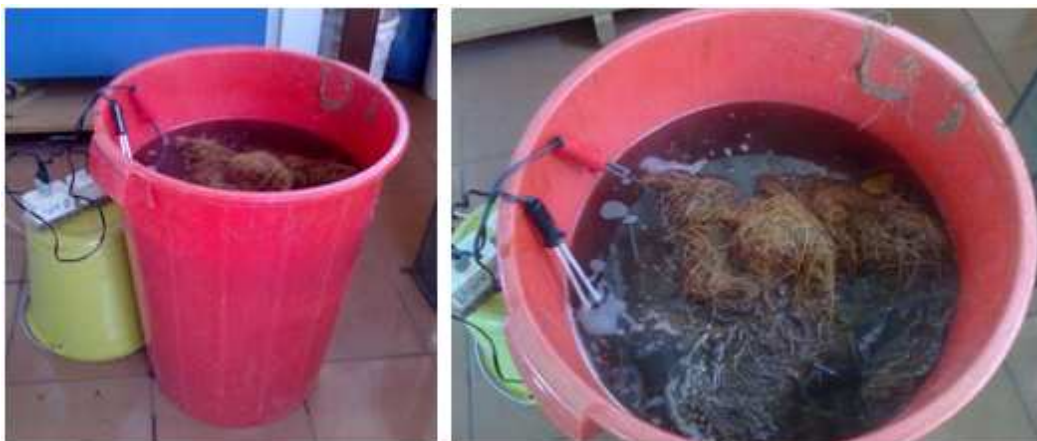
Figura 3.5: Fibras de coco imersas em água a 80°C
