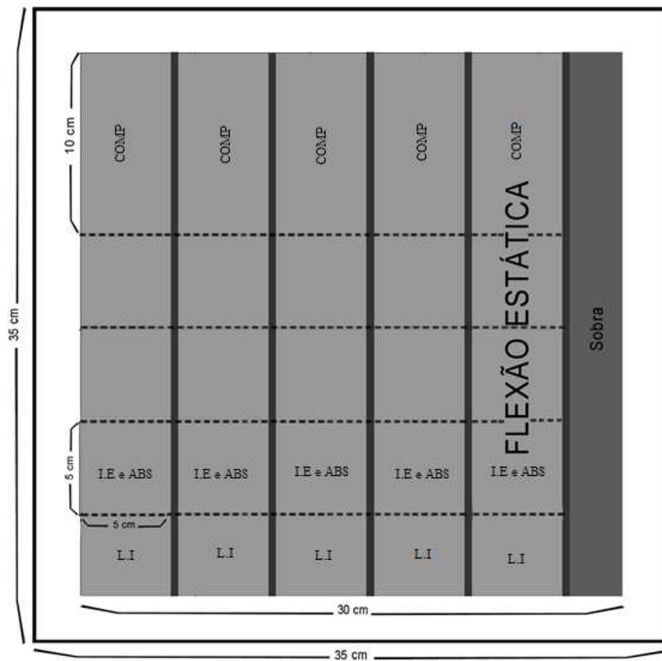
Figura 3.2: Esquema de distribuição dos corpos de prova nos painéis para avaliação das propriedades físicas e mecânicas
