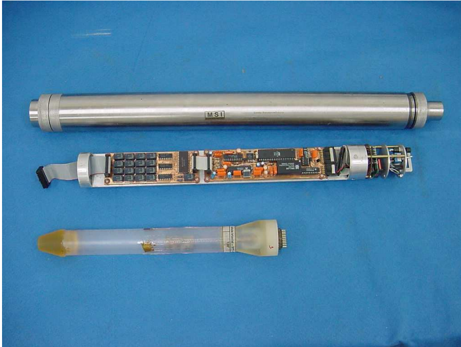
Figura 3.48 – Circuito eletrônico do Módulo de Aquisição de Dados, MAD modelo 1 e célula triaxial na parte inferior.
