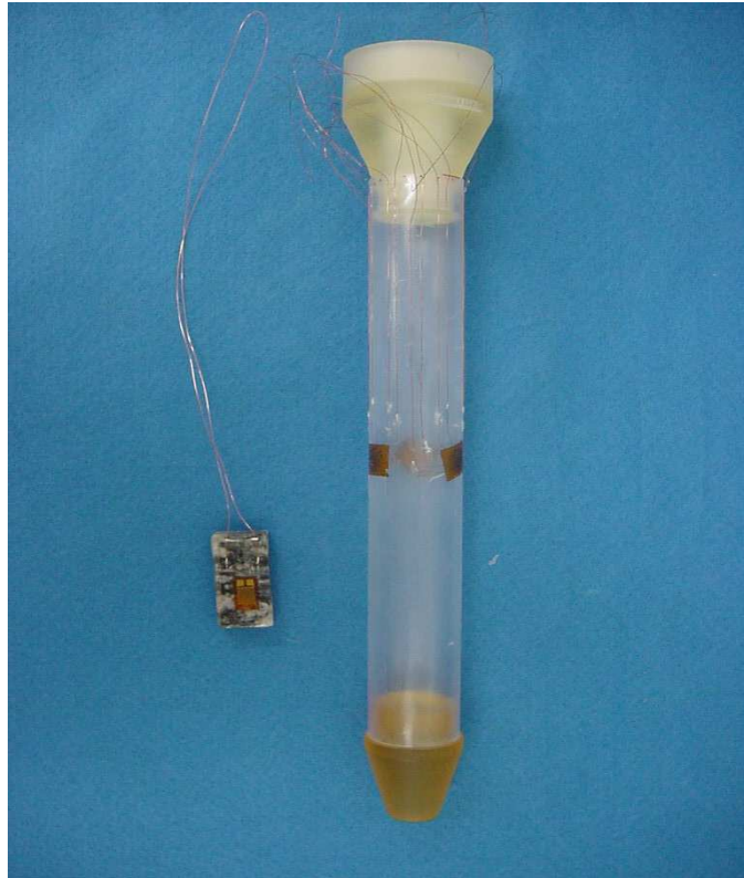
Figura 3.66 – Célula triaxial na posição vertical, tal como é colada no interior do furo.
