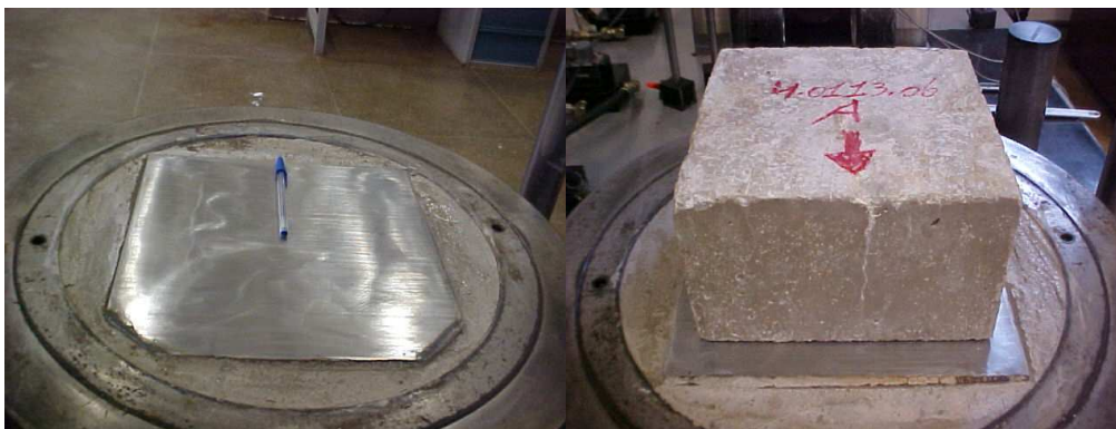
Figura 3.63 – Determinação do coeficiente de atrito entre a placa de aço e a argamassa dos blocos.
