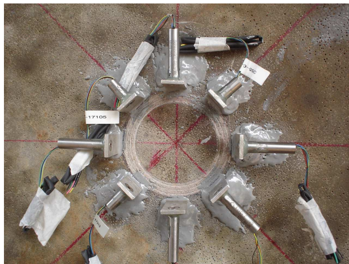
Figura 3.133 – Disposição dos LVDTs em torno do furo circular já demarcado.
