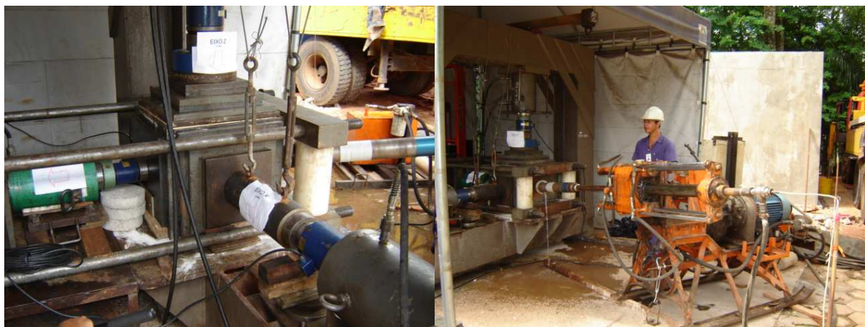
Figura 3.64 – À esquerda, montagem do ensaio triaxial cíclico, com indicações das direções de aplicação das três tensões. À direita execução da sobrefuração.
