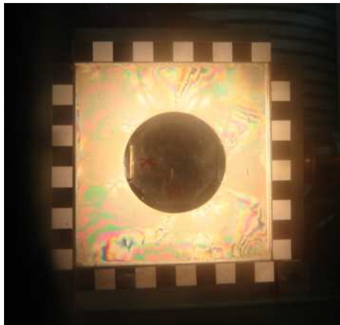
Figura 3.105 – Placa sob a mesma solicitação biaxial porém, com o pressômetro aplicando uma pressão interna \sigma_{xx} = 4 MPa e \sigma_{zz} = 2 MPa.
