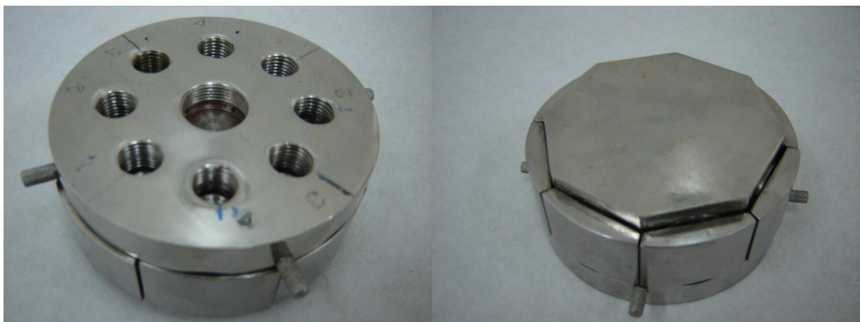
Figura 3.101 – À direita vista da parte superior com os oito orifícios de alimentação hidráulica. À esquerda vista da parte inferior. Em ambas as vistas podem ser observadas as oito sapatas (Patente FURNAS BRPI0604003).
