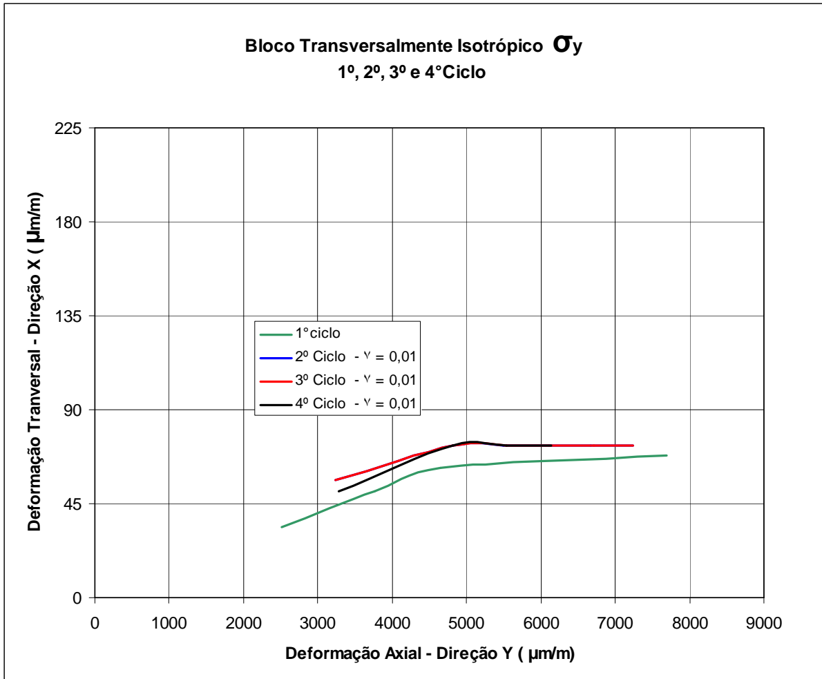
Figura 4.18 - Bloco transversalmente isotrópico com carregamento aplicado segundo a direção y para a obtenção do coeficiente de Poisson.
