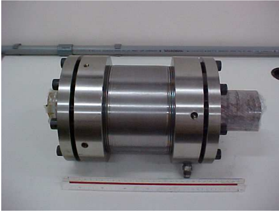
Figura 3.45 – Câmara biaxial com testemunho contendo a célula triaxial em seu interior sendo preparada para os testes.
