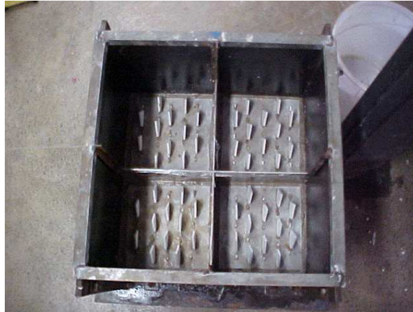
Figura 3.60 – Moldagem de quatro blocos ortotrópicos com dimensões de (25 x 25 x 25) cm.
