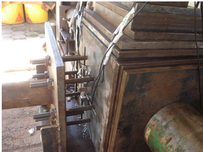
Figura 3.135 – Sistema de referência isolado no qual são apoiados os cursores dos LVDTs.
