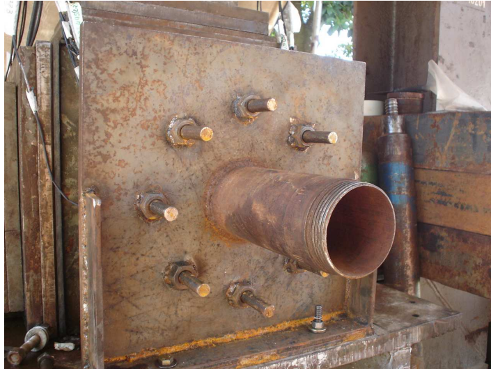
Figura 3.136 – Outra vista do sistema de referência com o tubo guia para o sistema de perfuração.
