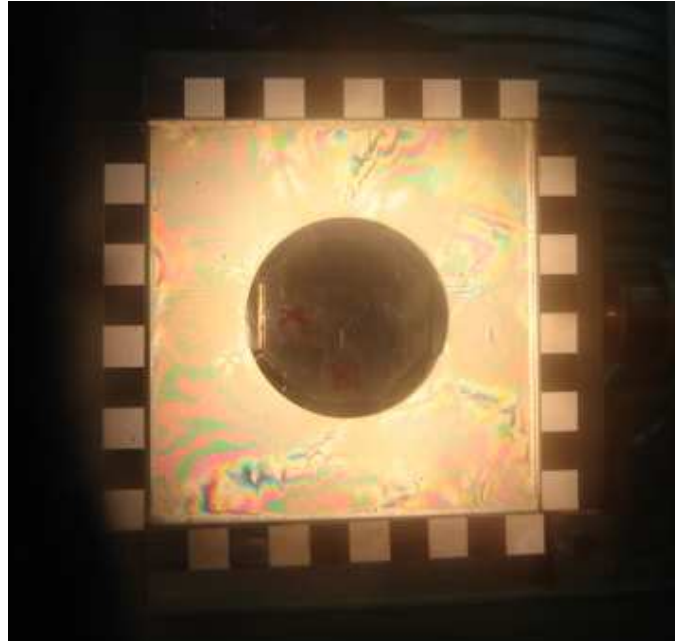
Figura 3.104 – Placa sob a mesma solicitação biaxial porém, com o pressômetro aplicando uma pressão interna \sigma_{xx} = \sigma_{zz} = 2 MPa.
