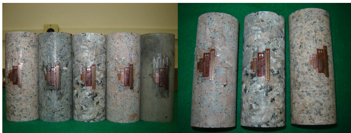
Figura 3.77 – Na foto à esquerda e da esquerda para a direita, observa-se o granito Serra da Mesa, granito azul microfissurado, granito porfirítico, granito vermelho e o basalto denso. À direita, três corpos-de-prova já com os quatro tipos de extensômetros elétricos colados.
