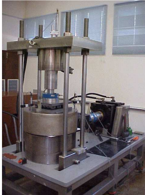
Figura 3.62 – Determinação do módulo de cisalhamento ou módulo transversal por meio de ensaios de cisalhamento direto em máquina servocontrolada.
