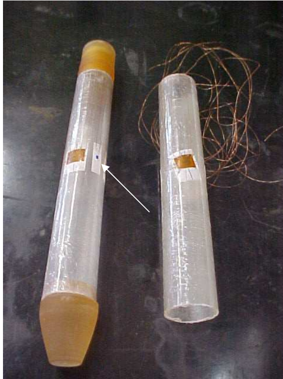
Figura 3.42 – À esquerda célula com as extremidades acopladas com destaque para o sensor de temperatura (seta). À direita, tubo com uma das rosetas extensométricas coladas.
