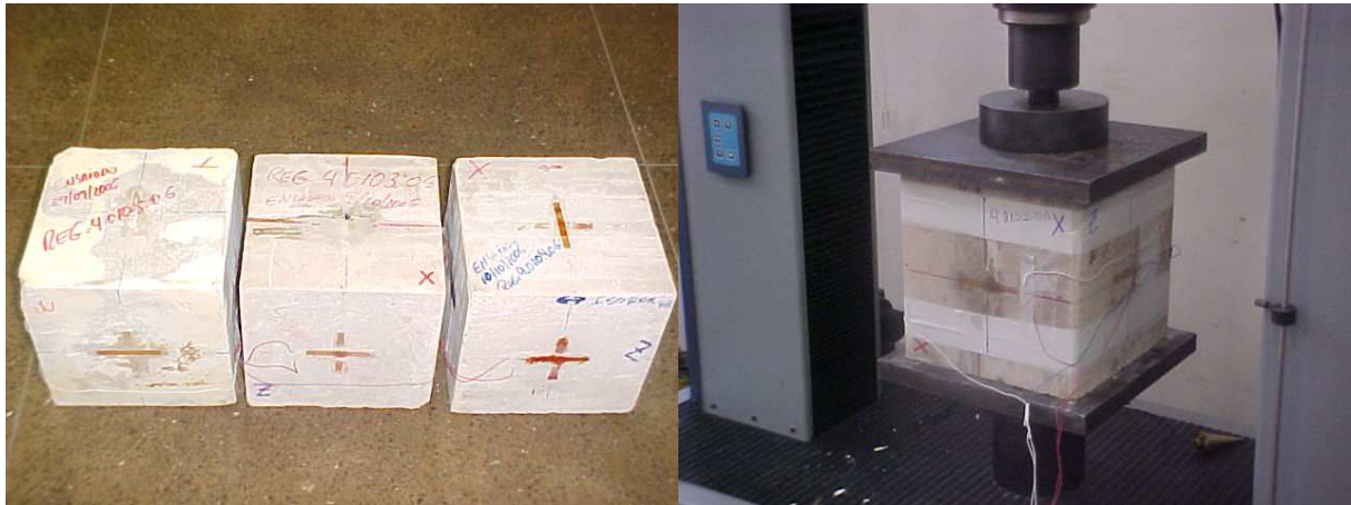
Figura 3.61 – À esquerda o conjunto de três blocos destinados aos ensaios de compressão uniaxial, notando-se nas laterais os extensômetros para a medição das deformações transversais. À direita ensaio em execução.
