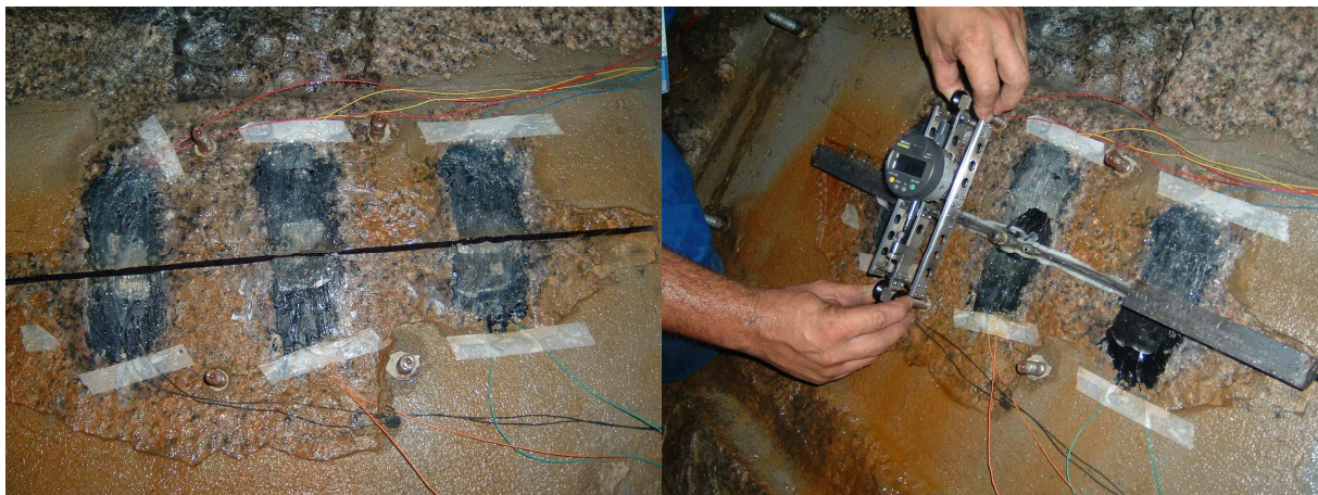
Figura 3.93 – Rasgo aberto em superfície rochosa para teste de reposição das deformações controlado por elementos de controle superficiais do tipo extensômetros elétricos de resistência.
