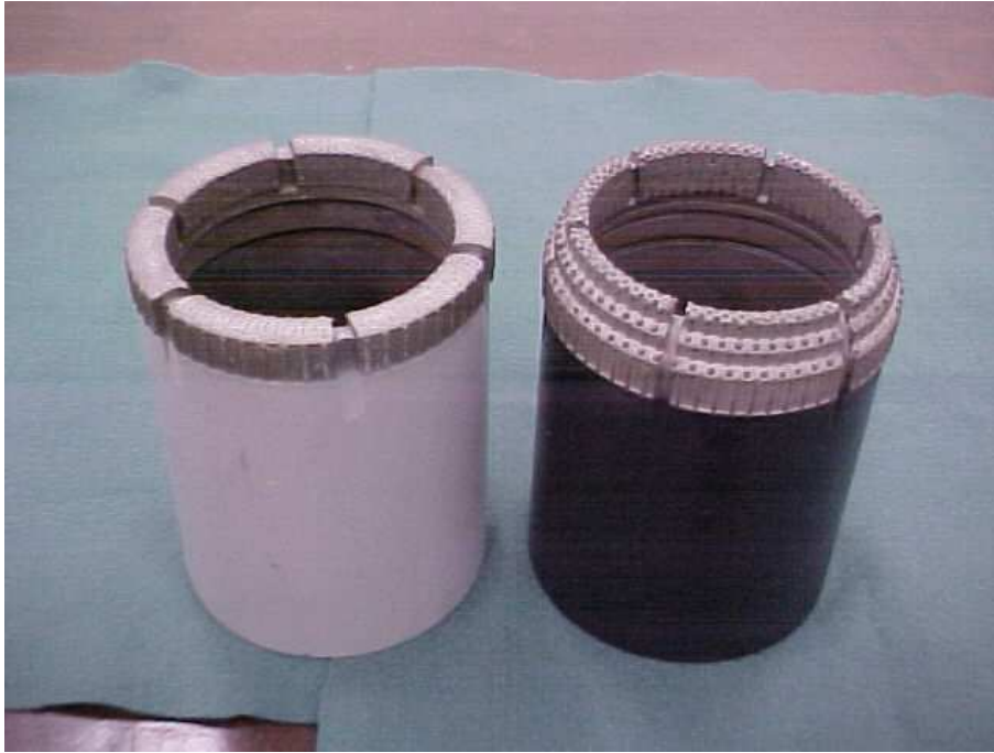
Figura 3.52 – À esquerda, coroa diamantada diâmetro HW, convencional. À direita, coroa escalonada diâmetro HW, especialmente desenvolvida para esse estudo.
