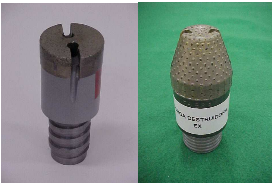
Figura 3.53 – Coroas destruidoras diâmetro EW, com face plana à esquerda e tronco-cônica à direita.
