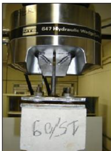
Figura 3.29 – Detalhe da barra para fixação do corpo-de-prova na MTS (Uchôa, 2007)
