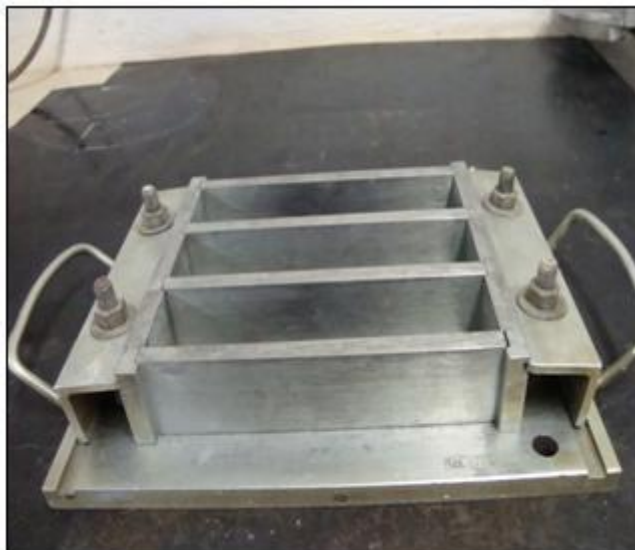
Figura 3.17 – Sequência de moldagem dos corpos de prova usados nos ensaios de densidade de massa, absorção, índice de vazios, massa específica, resistência à tração na flexão e resistência à compressão.
