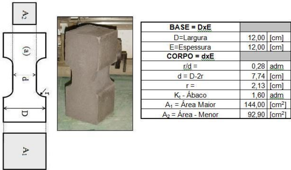
Figura 3.28 – Geometria do corpo-de-prova do ensaio à fadiga sob tração (Uchôa, 2007).
