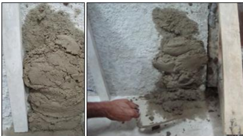
Figura 3.8 – Avaliação táctil-visual de argamassas de diversos traços.
