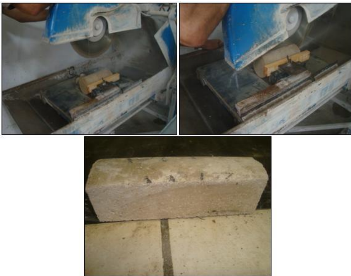
Figura 4.4 – Processo de obtenção dos corpos-de-prova prismáticos a partir dos corpos-de-prova cilíndricos.
