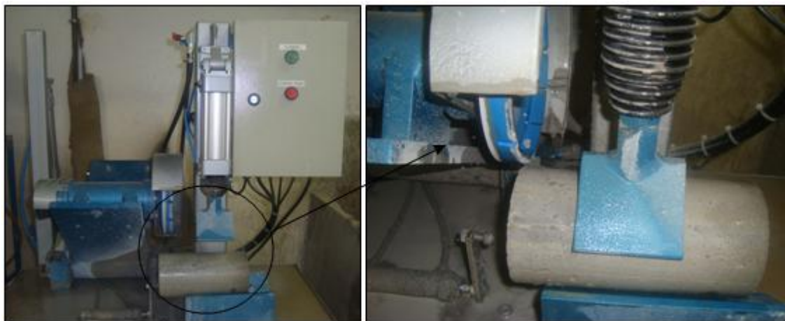
Figura 3.31 – Processo de retificação dos corpos-de-prova usados no ensaio de fadiga.
