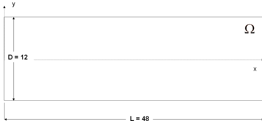
Figura 3.3 - Dimensões ( D igual a 12 e L igual a 48 unidades de comprimento) e sistema de coordenadas do domínio \Omega .
