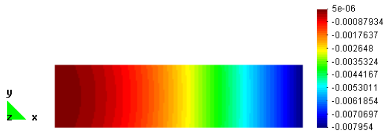
Figura 5.71 - Campo de deslocamento em y : função peso quártica; d_{max} = 2,5 , 85 nós e k = 12 .
