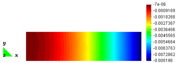
Figura 5.102 - Campo de deslocamento em y: 52 nós, 40 células, d_{max} = 1,0 , função peso cúbica e k = 22.
