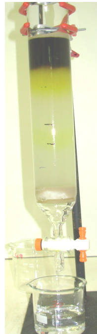
Figura 4: Siparuna guianensis : Coluna cromatográfica aberta de sílica gel da fase ativa, oriunda da partição líquido-líquido do extrato: sistema de eluentes: Ciclohexano:Acetato de etila:Metanol
