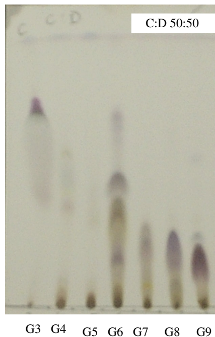
Figura 8: Siparuna guianensis : Cromatografia em camada delgada dos grupos G3, G4, G5, G6, G7, G8 e G9. C: ciclohexano; D: diclorometano. Revelador: vanilina sulfúrica
