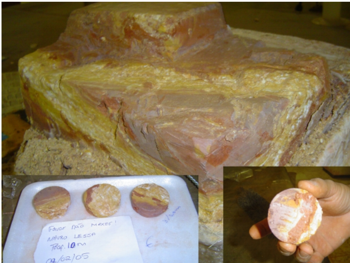
Figura 6.42 – Corpos de provas moldados para o ensaio de sucção, profundidade = 10m.
