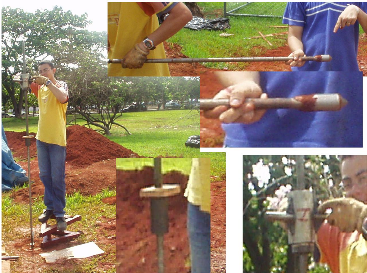
Figura 5.13 – Execução do ensaio de DPL.
