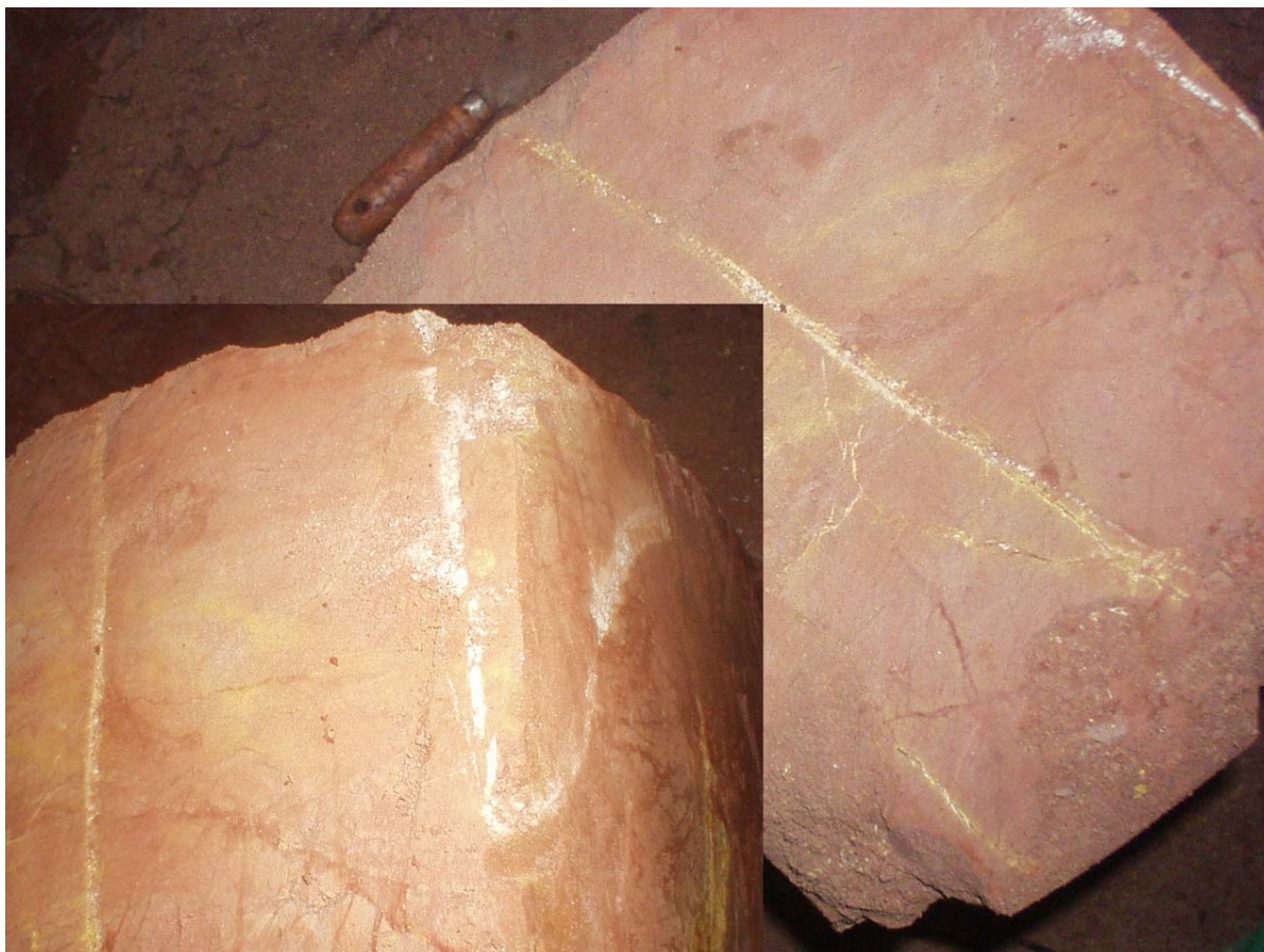
Figura 6.30 – Bloco moldados in loco do Campo Experimental da UnB, Profundidade = 9m.
