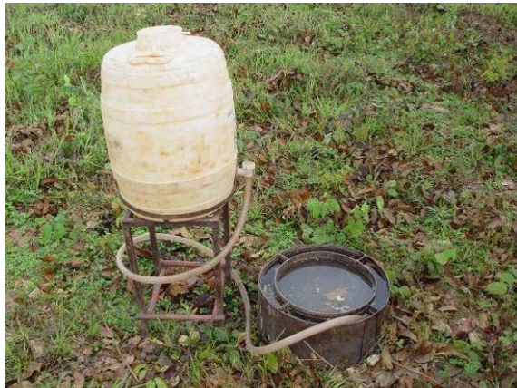
Figura 18. Esquema para o método dos anéis concêntricos.
