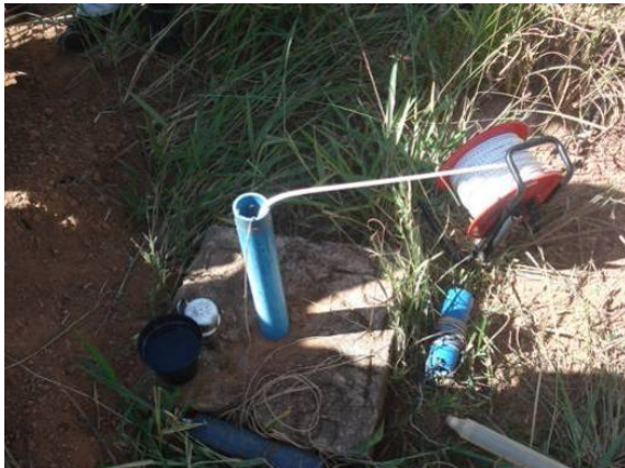
Figura 20. Medidor de nível.
