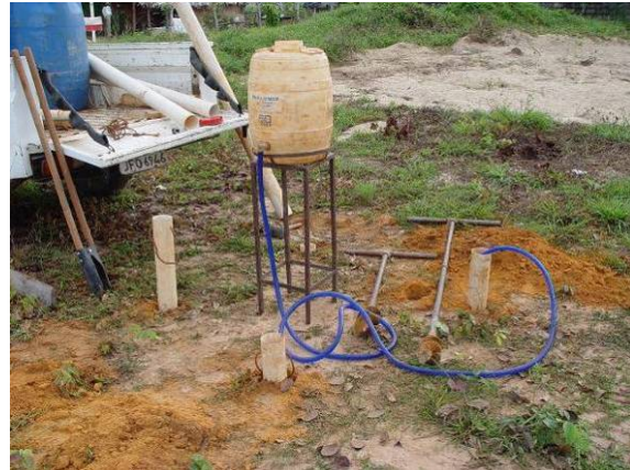
Figura 19. Esquema para o método open end hole .
