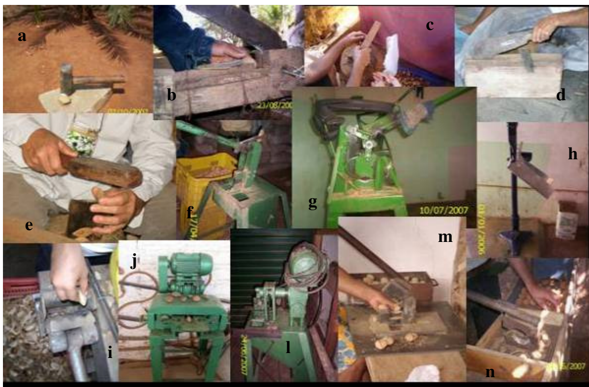
FIGURA 3.3. – Técnicas de beneficiamento dos frutos: a) quebra com marreta; b) foice artesanal; c) lâmina e porrete; d) facão adaptado; e) machadinha fixada e porrete; f) quebradeira manual de baru; g) cópia da quebradeira; h) quebradeira com pedal; i) quebradeira automática; j) quebradeira elétrica de baru com lâminas horizontais; l) quebradeira elétrica de baru com lâminas transversais e m) e n) as duas últimas são modelos semelhantes de quebradeiras manuais com apoio para as mãos.
