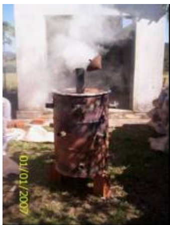
FIGURA 5.7. – Tambor adaptado para carbonização do endocarpo dos frutos.
