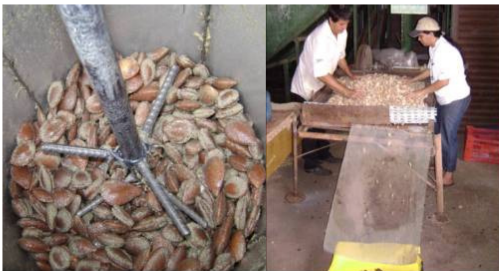
FIGURA 5.2. – Despolpador e mesa de separação da U.P. Pró Baru.
