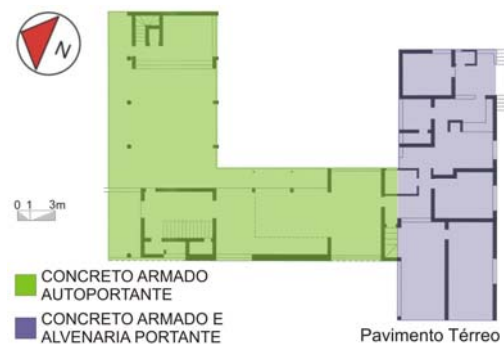
fig. 46. Casa Zenon Rocha: planta do pavimento térreo, assinalando os tipos de estruturas
