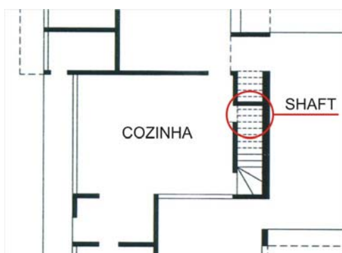
fig. 71. Casa David Cortellazzi: shaft para instalações elétricas
