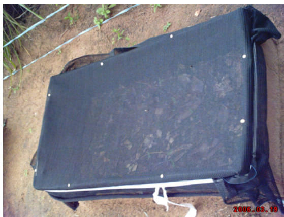
Figura 12 Estrutura adotada para evitar a contaminação do material fértil em parcelas testemunhas, utilizado no método de serapilheira, localizado na Universidade Federal do Tocantins – UFT.
