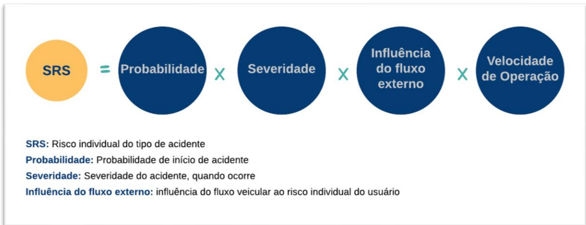
Figura 2.16 Modelo de Cálculo Probabilístico para Classificação por Estrelas Fonte: IRAP, 2022c.
