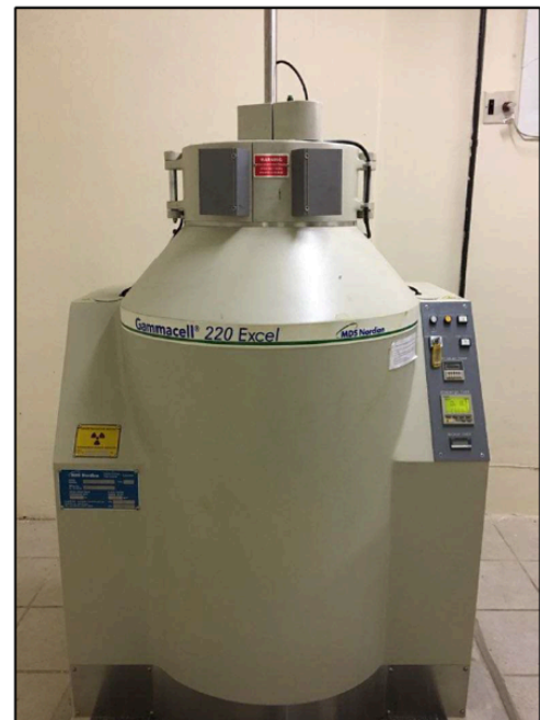
Figura 21. Em (a) é mostrado as amostras de h-BN/SiO 2 /Si, h-BN/Pt/c-safira e h-BN/Cu/SiO 2 /Si originais e exemplos do recorte que foi feito das amostras originais para que fosse irradiados no Irradiador Co-600 Novo (Gammacel 220 Excel) mostrado em (b).
