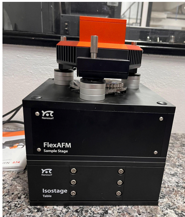
Figura 19. AFM utilizado para caracterização topográfica dos materiais trabalhados nessa pesquisa. Equipamento da NanoSurf, modelo FlexAFM.
