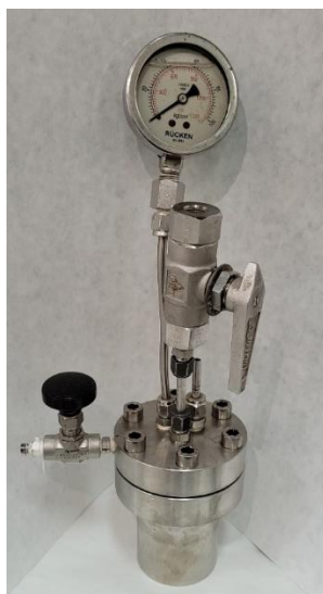
Figura 42. Reator do tipo autoclave com copo de vidro utilizado nos testes de atividade catalítica.
