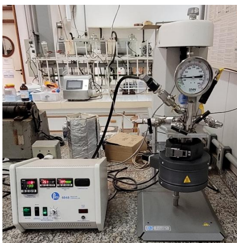
Figura 41. Reator Parr modelo 4590 HP utilizado nos testes catalíticos.
