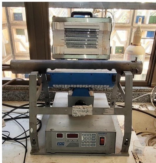
Figura 20. Forno tubular com tubo de aço utilizado nos ensaios de torrefação e pirólise.
