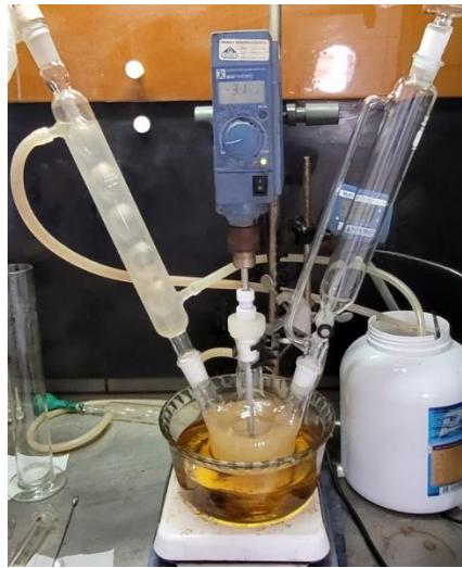
Figura 17. Montagem do sistema de epoxidação de óleo de bicho da seda.
