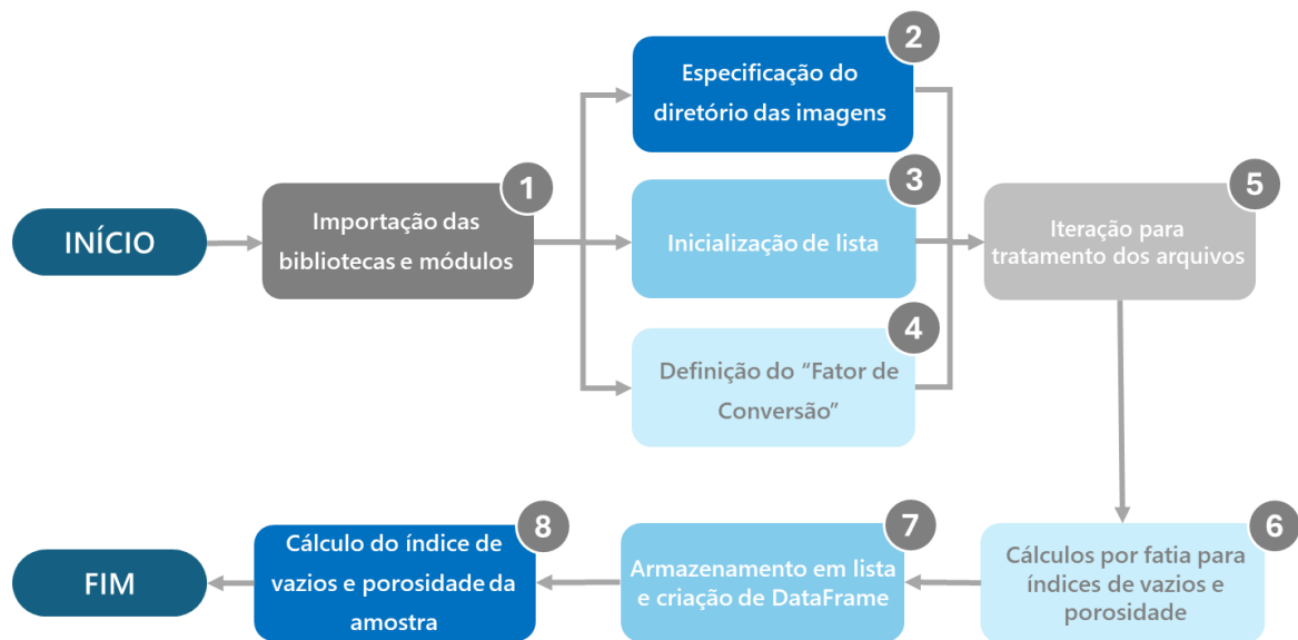
Figura 3.23. Esquematização simplificada do algoritmo de índice de vazios e porosidade para a areia
