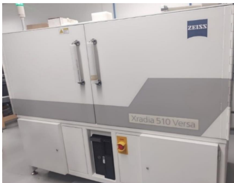
Figura 3.9. Microtomógrafo computadorizado de raio-X modelo ZEISS Xradia 510 Versa
