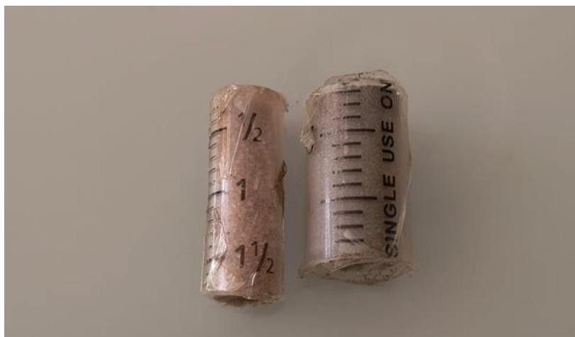
Figura 3.8. Acondicionamento das amostras de rejeito de minério de ferro - R (esquerda) e rejeito de minério de ferro estabilizado com polímero - RP (direita)
