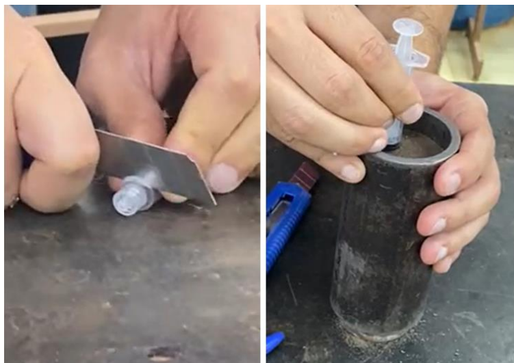
Figura 3.7. Preparação da amostra de compósito de rejeito de minério de ferro com polímero para microtomografia computadorizada de raio-x
