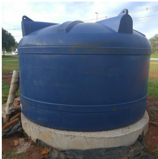
Figura 3.9. Primeiro carregamento do Modelo de Referência com o tanque de 10 m 3 .
