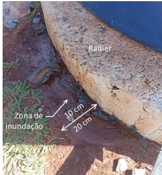
Figura 4.18. Zona de inundação registrada na superfície ao final da simulação física do Modelo de Referência.
