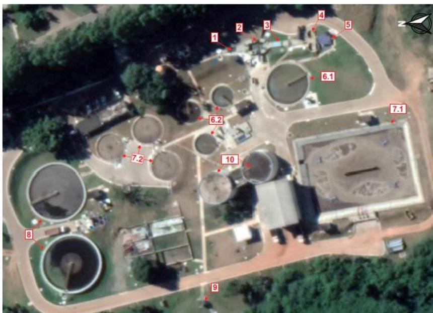
**Legenda:** 1- By pass e Gradeamento grosso; 2- Gradeamento fino; 3- Calha Parshall; 4- Desarenadores tipo Ciclone; 5- Caixa divisora de vazão; 6.1- Decantador primário maior; 6.2- Decantadores primários menores; 7.1- Tanque Pulmão; 7.2- Reatores Aerados; 8- Decantadores Secundários; 9- Lançamento Final da ETE; 10- Digestores anaeróbios de lodo.
