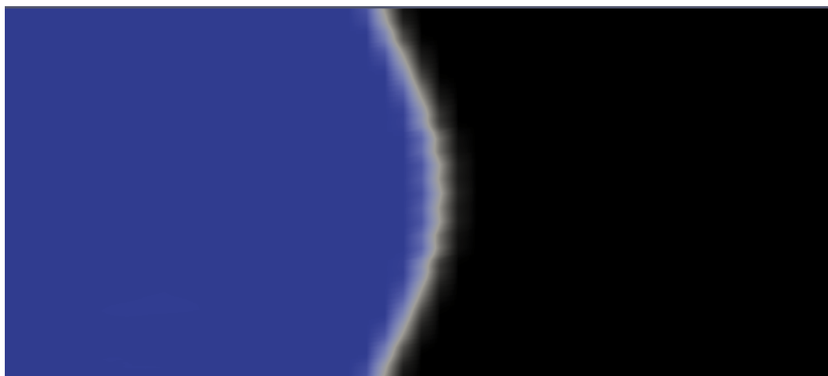
Figura 5.50 – Escoamento bifásico em uma célula de Hele-Shaw com Ca_c = 0.0006 e t = 0.485 s.
