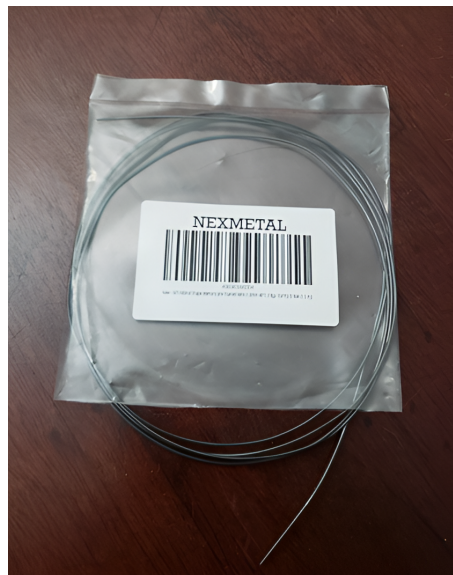
Figura 21 – Liga de memória de forma para a realização do experimento. Fonte: A autora.
