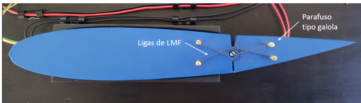
Figura 22 – Posição de fixação e deformação dos fios de LMFs como atuadores do protótipo. Fonte: A autora.
