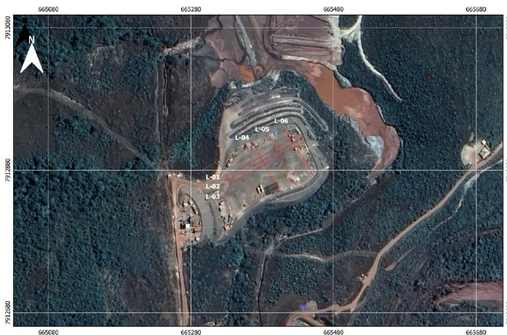
Figura 3.8: Alinhamentos geofísicos executados no aterro experimental
