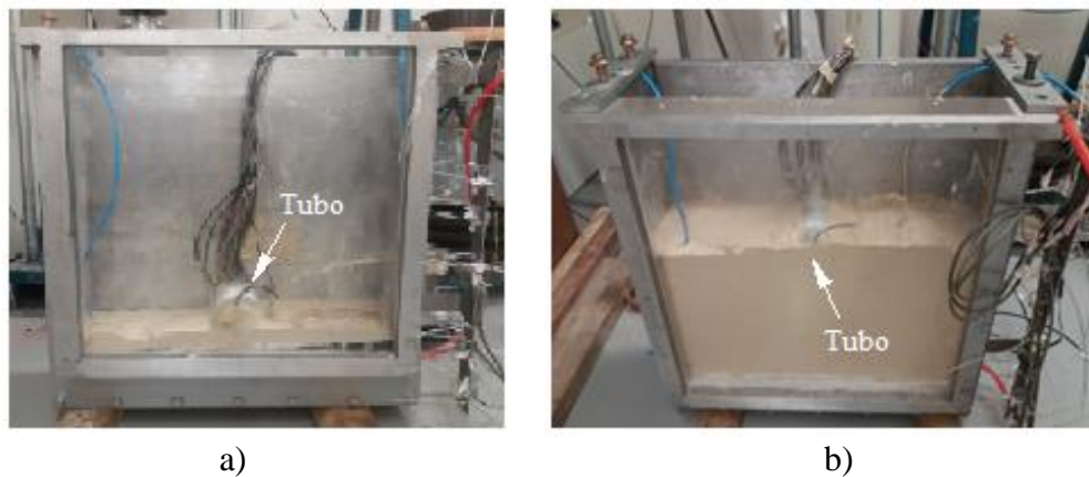
Figura 3-8. Colocação do solo mole e do tubo nos modelos: a) Modelo N° 1; b) Modelo N° 2 (Pérez-León, 2023)
