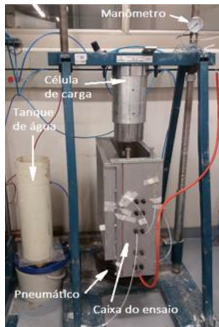
Figura 3-11. Etapas finais do processo de adensamento, uso de sistema pneumático para o carregamento (Pérez-León, 2023)
