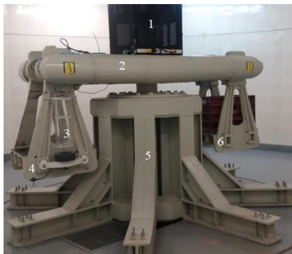
Figura 2-6. Centrífuga geotécnica utilizada em Pérez-León, 2023. 1) Painel de aquisição de dados; 2) Braço; 3) Tanque de controle de água; 4) Plataforma para caixas de modelagem; 5) Motor; 6) Plataforma de contrapeso (Pérez-León, 2023)
