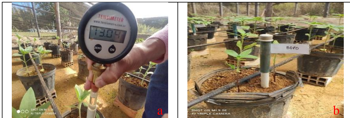
FIGURA 6. Tensímetro digital (a) e tensiômetro (b) instalado nos vasos com doses de BLE de 0, 2, 4, 6 e 8% v/v, independente das doses de PR.
