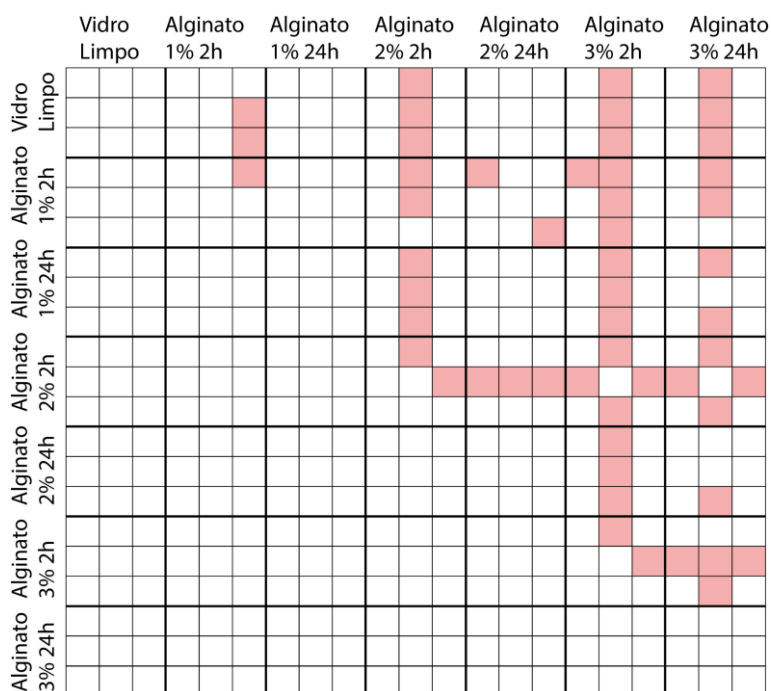
Figura 55 - Análise estatística realizada utilizando as comparações pareadas por análise de variância One-Way ANOVA ( P < 0,05 ) aplicando o teste de Tukey. Os quadrados demarcados em vermelho representam as combinações estatisticamente distintas do método empregado.
