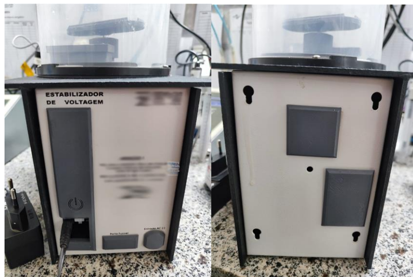
Figura 22 - Tampas externas impressas em 3D e encaixadas na carenagem.
