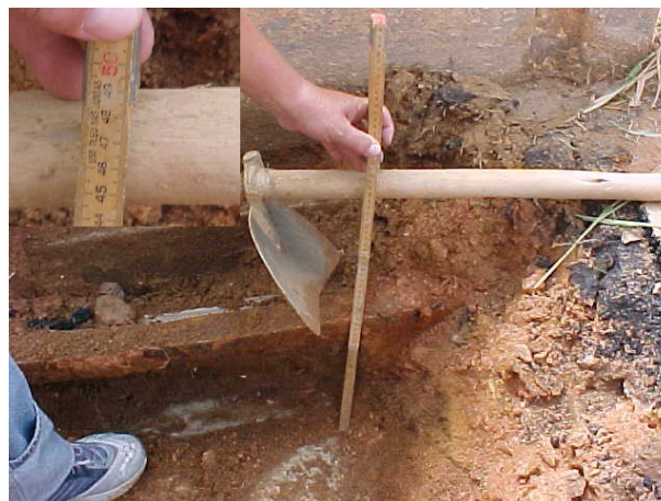
FIGURA 5. MEDIÇÃO DA CAMADA NO TABULEIRO DA PONTE
