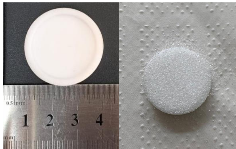
Figura 5. Porta amostra em detalhe utilizado para as medidas no MicroNIR à esquerda, à direita, porta-amostra contendo edulcorante xilitol.
