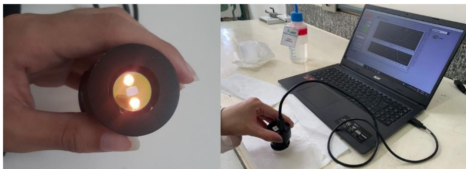
Figura 6: Parte frontal do espectrômetro à esquerda, à direita, o MicroNIR durante uma medida.
