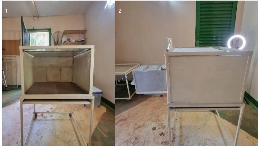
Figura 3.6. Fotografias do Campo Aberto (CA) na sala de experimento, localizado a 50 m dos viveiros de moradia dos micos-estrela. (1) Vista frontal do aparato mostrando a parede lateral de vidro; (2) Vista lateral do aparato, evidenciando a parede lateral de alumínio e a caixa-transporte acoplada à porta tipo-guilhotina.
