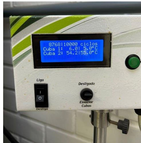
Figura 8 – Amostras do grupo 2 na cuba termocicladora durante os 10.000 ciclos. Temperaturas da água alternadas entre 5°C e 55°C.
