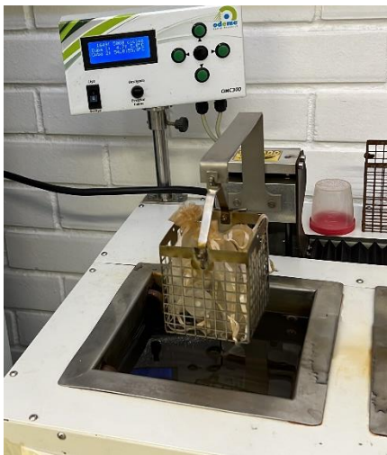
Figura 8 – Amostras do grupo 2 na cuba termocicladora durante os 10.000 ciclos. Temperaturas da água alternadas entre 5°C e 55°C.
