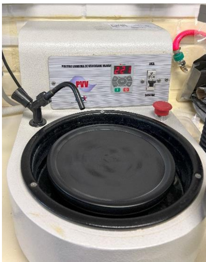
Figura 4 – Politriz circular de velocidade variável (Teclago, São Paulo) com lixa de polimento granulação #180.
