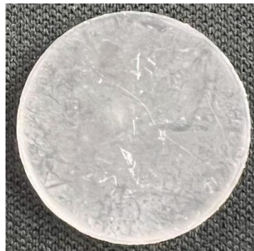
Figura 2 – Amostra cilíndrica impressa em resina Splint 3D e pós-tratadas.
