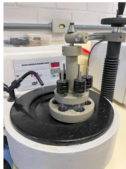
Figura 4 – Politriz circular de velocidade variável (Teclago, São Paulo) com lixa de polimento granulação #180.
