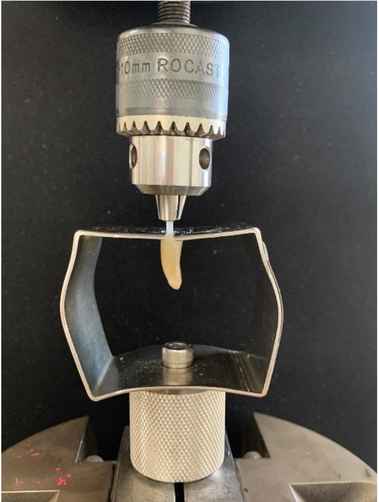
Figura 4 – Aparato de fixação do espécime para realização do teste pull-out.
