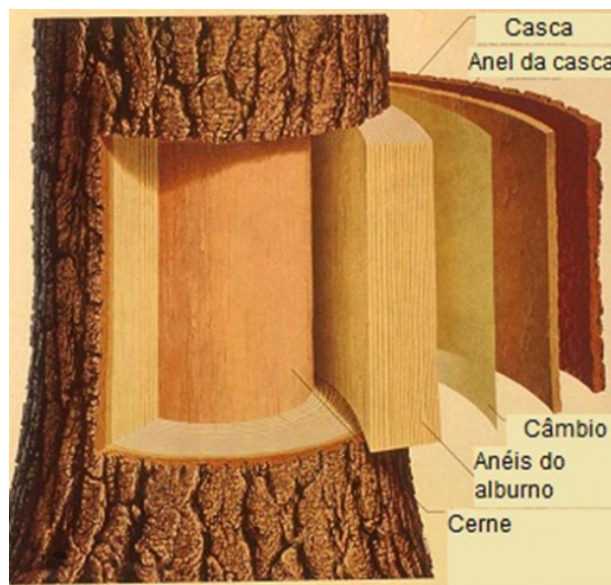
Figura 2.1 Desenho esquemático de corte transversal no tronco de uma árvore (Fonte desconhecida)
