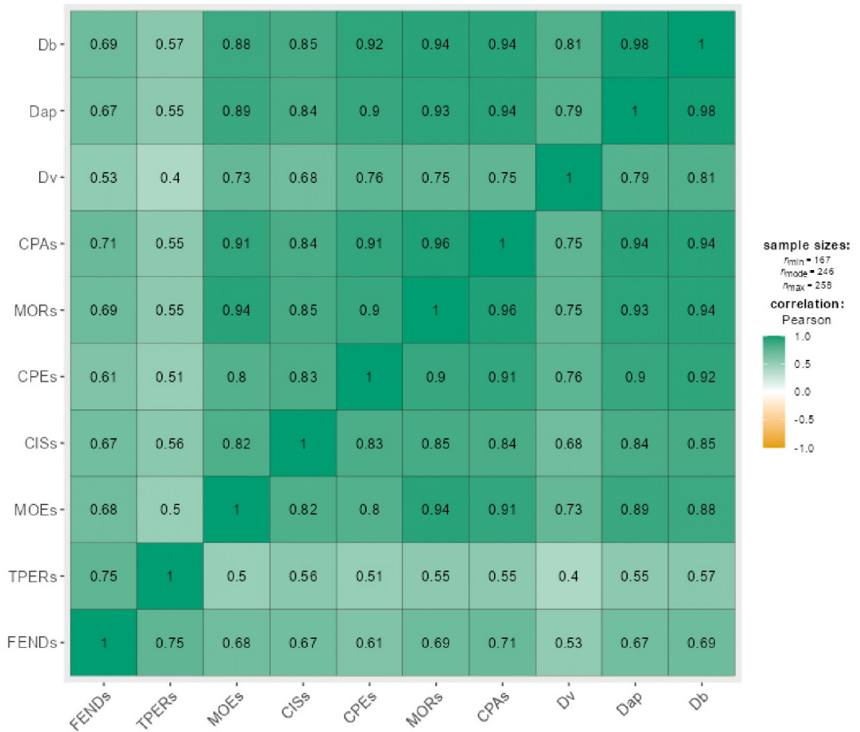
Figura 3.11 Matriz de correlação de Pearson com a consideração contínua da força de variáveis, em tons de verde) para madeira seca (teor de umidade de 12%)
