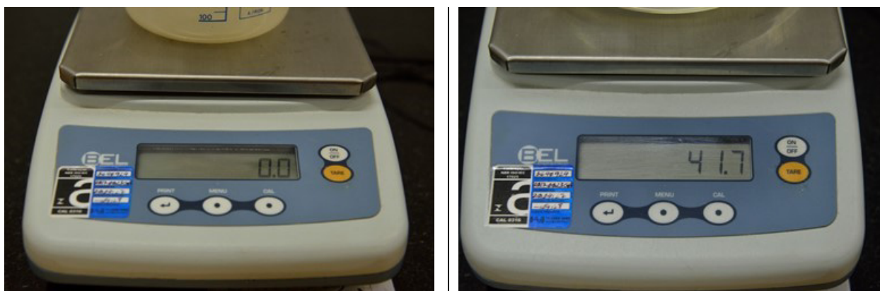
Figura 2.8: Determinação do volume do corpo de prova saturado por imersão em água para cálculo da densidade básica da madeira (Fotos: do autor).
