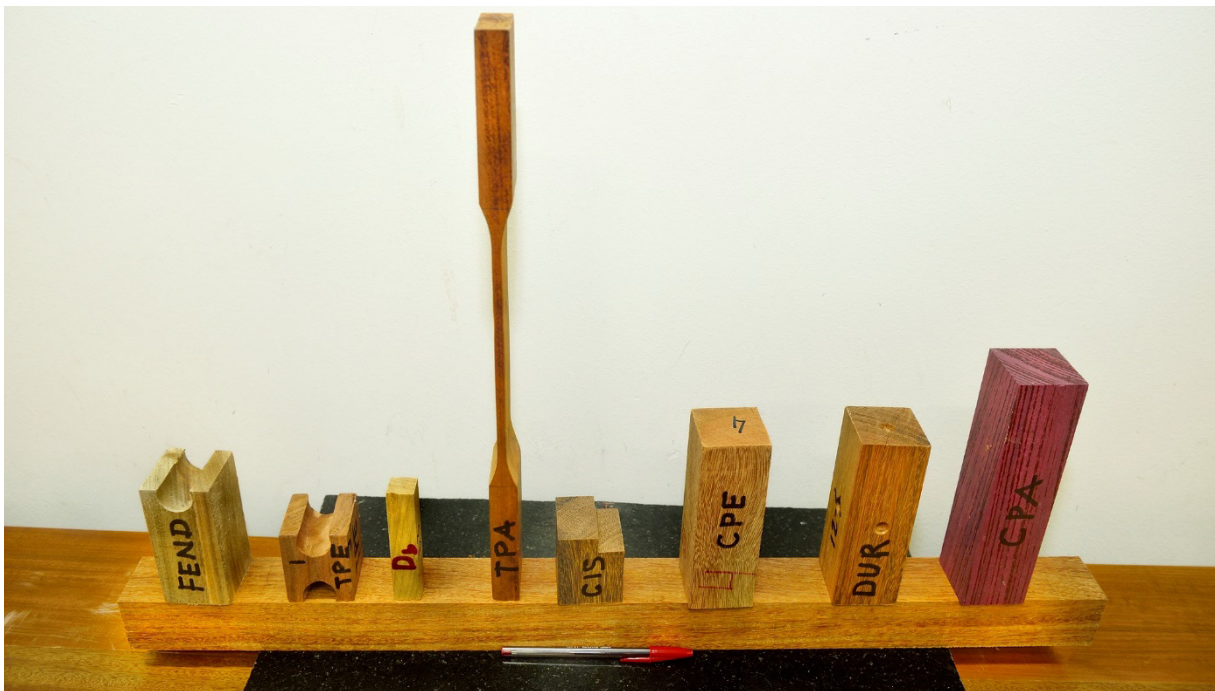
Figura 2.5: Corpos de prova para ensaios segundo normas da COPANT (Foto: do autor)
