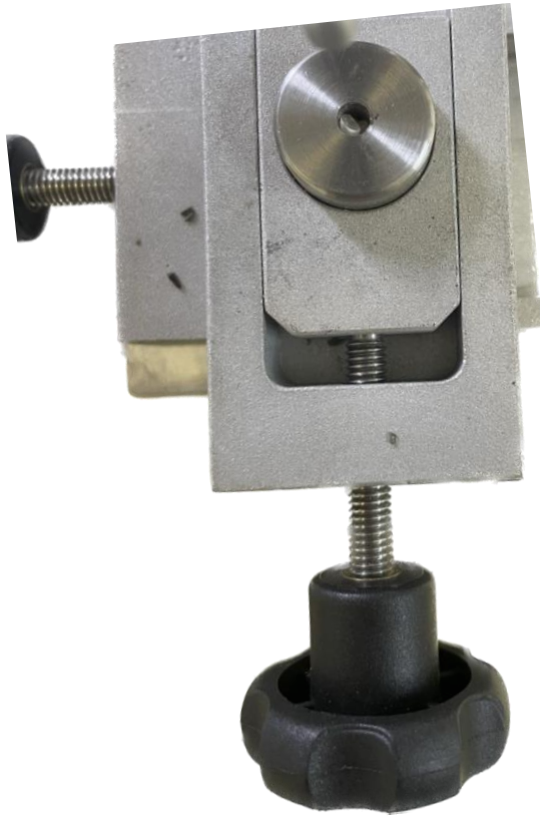
Figura 8 - Imagem de vista superior da base onde é posicionada a amostra para o teste de push-out
