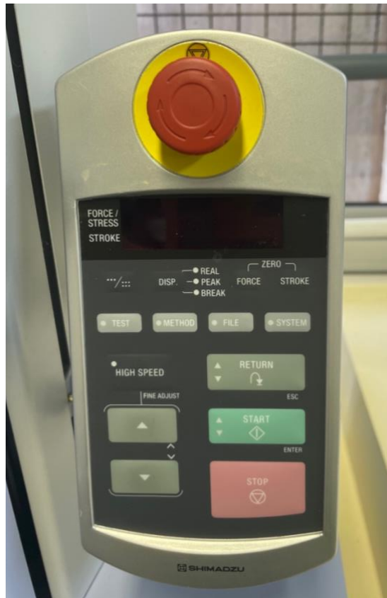
Figura 9 - Imagem da base de controle das informações de força, tempo, início e pausa do teste a ser executado
