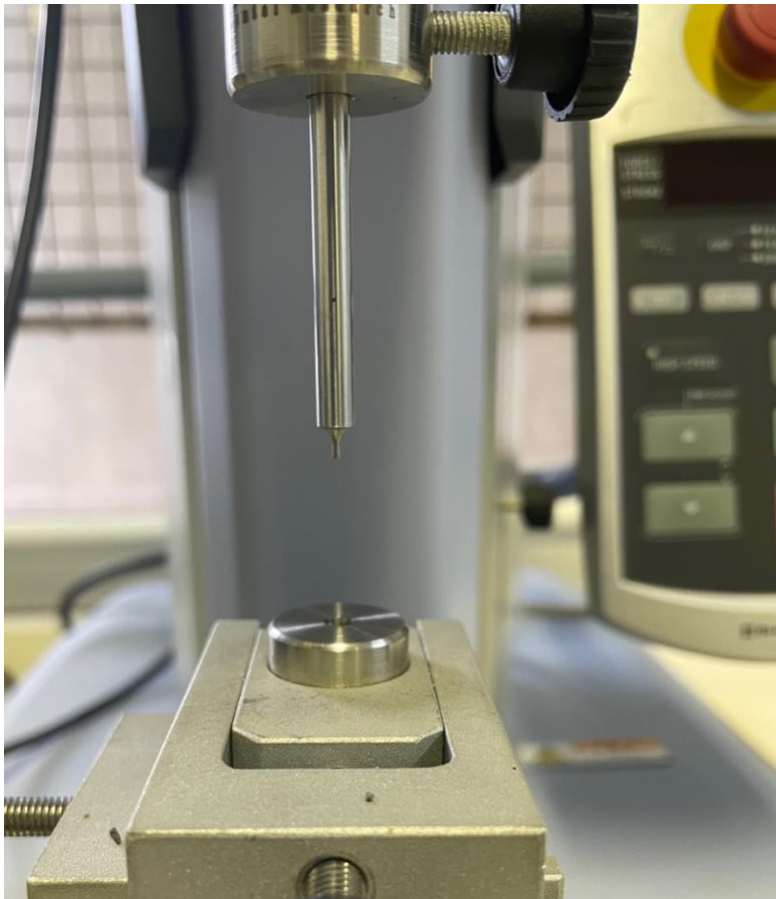
Figura 7 - Imagem da máquina EZ Test Compact table-top Universal tester preparada para a realização do teste de push-out
