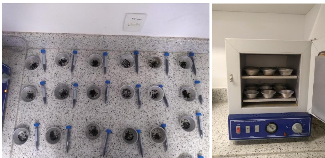
Figura 2.1 - Processo de secagem do carvão
