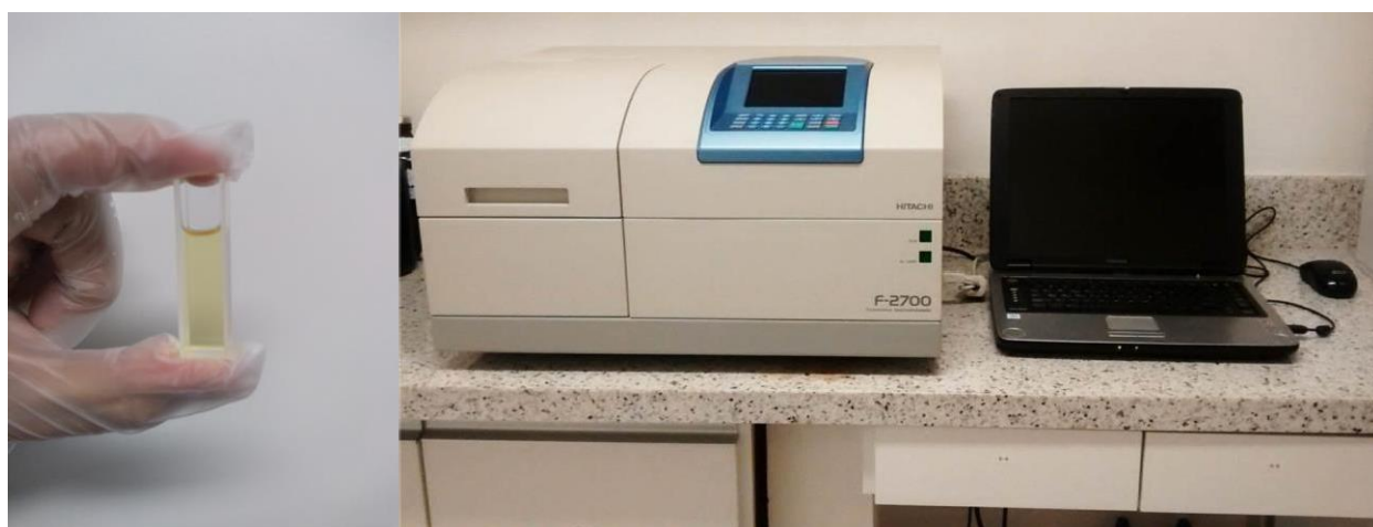
Figura 2.3 - Cubeta de quartzo eluente e espectrofotômetro de fluorescência HITACHI F-2700 acoplado ao computador
