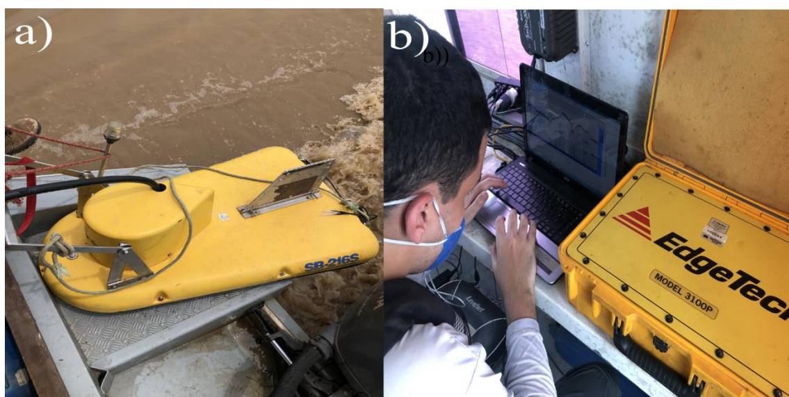
Figura 33 - a) Equipamento EDGETECH 3100 com transdutor SB216S, foto anterior à aquisição de dados com o próprio na superfície b) Equipamento TOPSIDE da empresa EdgeTech, representado pela maleta amarela, e o notebook em que há a visualização de dados de perfilagem sísmica (Fotografia do Autor).
