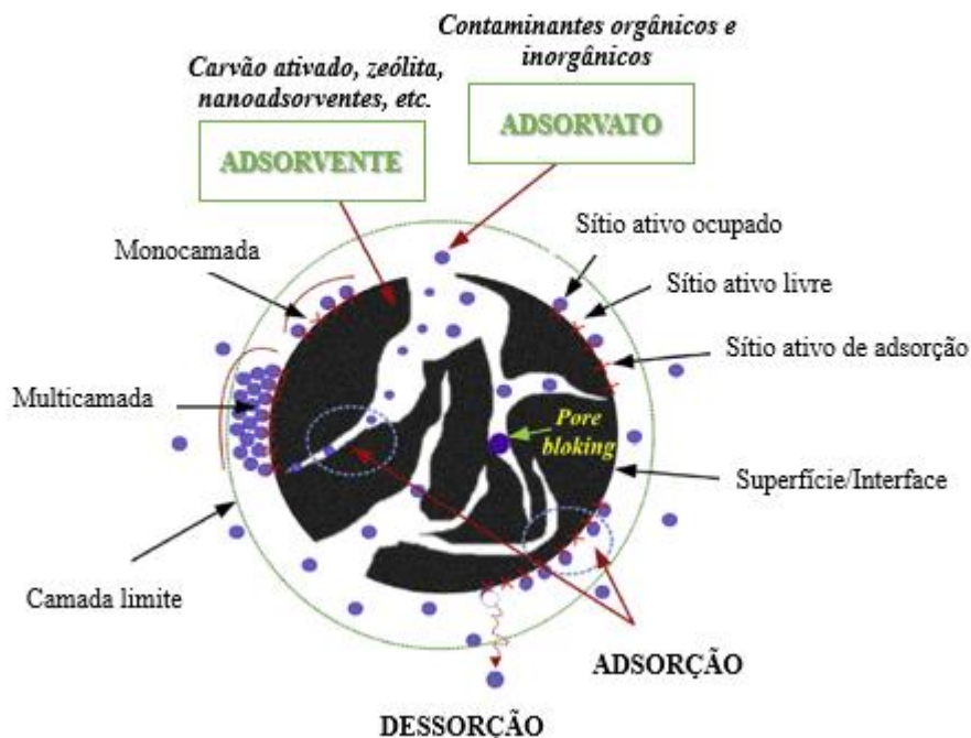
Figura 3. 3. Esquema ilustrativo dos termos comuns usados em processos adsorptivos. (Tran et al. , 2017, Adaptado).
