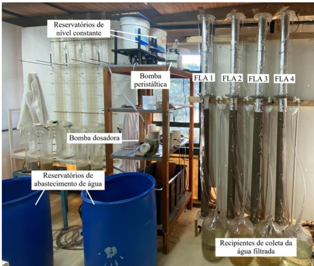
Figura 4.3: Fotografia da instalação experimental de filtração lenta convencional em areia em escala piloto utilizada na realização deste trabalho. Fotografia capturada por Thatiane de Souza Tavares
