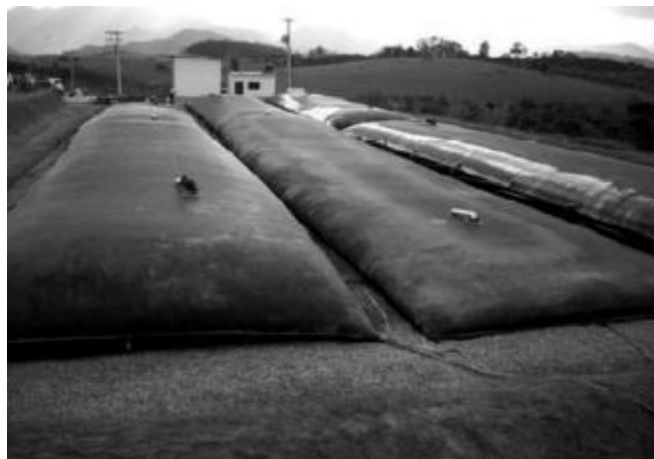
Figura 2.14 - Tubos de geotêxteis para o dessecamento de lodos na Cidade de Rio das Ostras, RJ, Brasil (Castro et al. , 2008)
