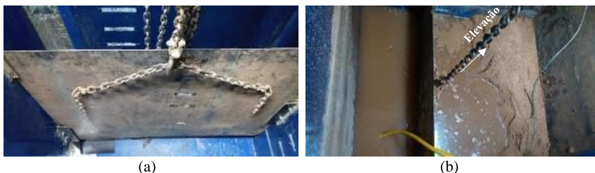
Figura 3.3 - Reservatório e área de mistura; (a) chapa de aço suspensa dentro do reservatório, (b) separação da água e solo saturado antes do processo de mistura.
