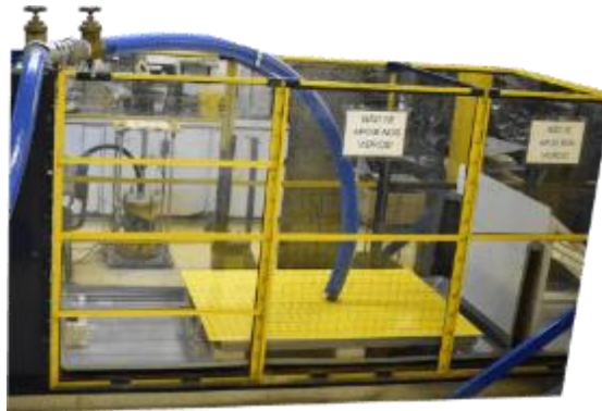
Figura 3.8 - Vista geral da área de enchimento dos tubos de geotêxtil.
