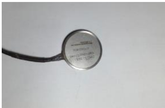
Figura 3.16 - Célula de tensão total utilizada na pesquisa.
