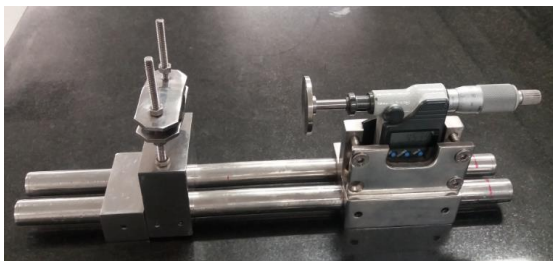
Figura E.4. Calibração do LVDT tipo LD400-2,5. a) Equipamento de calibração; b) Curva de calibração.
