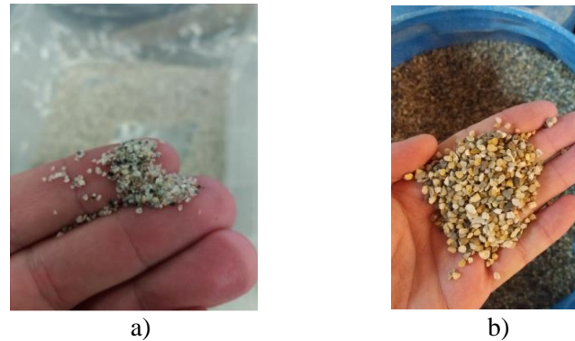
Figura 5.6. Materiais granulares utilizados na pesquisa. a) Areia média utilizada na camada superior; b) Areia grossa utilizada na camada de drenagem.
