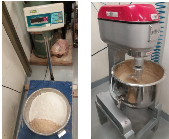
Figura 4.11. Dosagem e mistura 50% caulim - 50% TD com água por meio de um misturador industrial.
