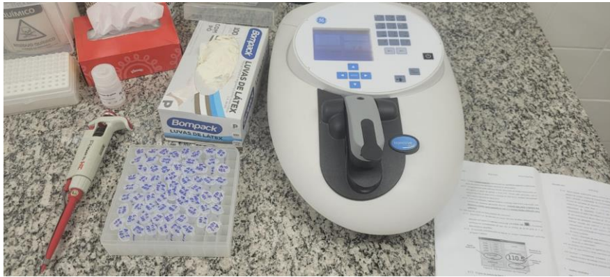
Figura 5 - Aparelho NanoVue™ Plus (GE Healthcare, UK) para análise espectrofotométrica. Arquivo pessoal.
